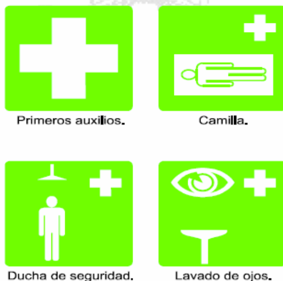
Figura 4.28: Esquema de señalización de salvamento y socorro
