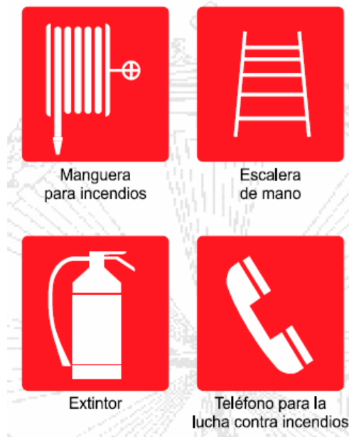
Figura 4.29: Esquema de señalización de equipos contra incendio
