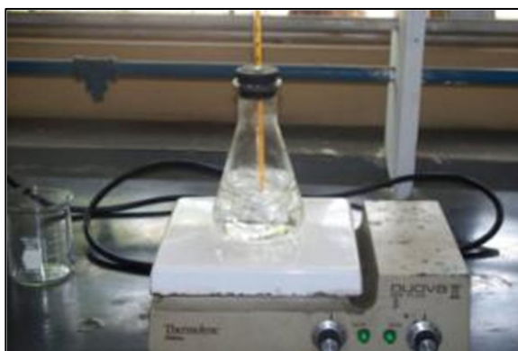
Figura 3. 3. Disolución del ánodo en medio ácido.
