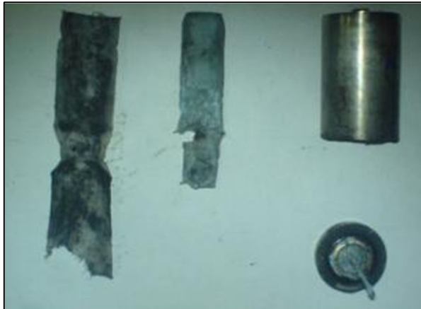
Figura 3. 2. Separación de membrana del ánodo de pila alcalina.
