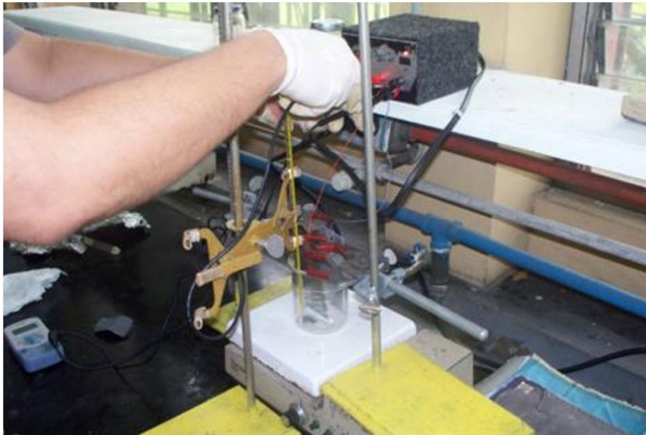
Figura 3. 5. Proceso de electrodeposición en pila alcalina.
