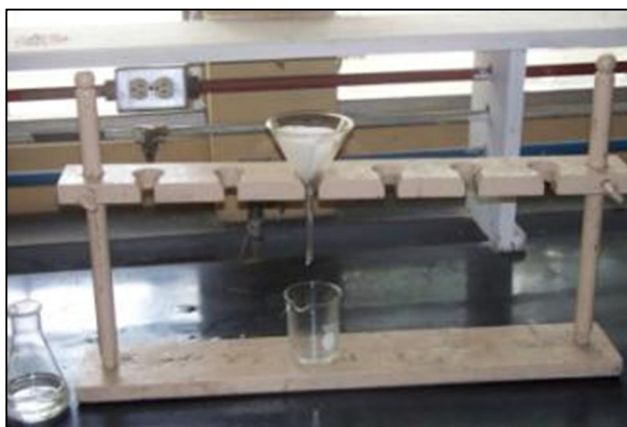
Figura 3. 4. Filtrado de lixiviado.
