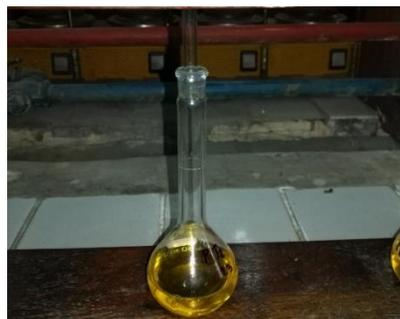
Aforar los balones volumétricos con agua bidestilada y homogenizar.
