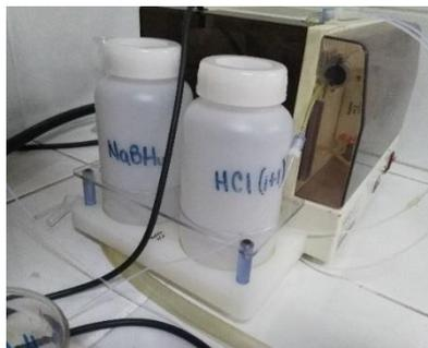
Colocar en el equipo EAA 500 mL de NaBH<sub>4</sub> y 500 mL HCl (1:1).
