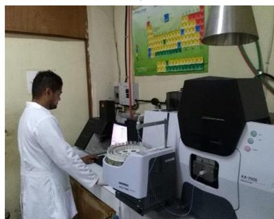
Encender el equipo de EAA e introducir los parámetros para el elemento a analizar.
