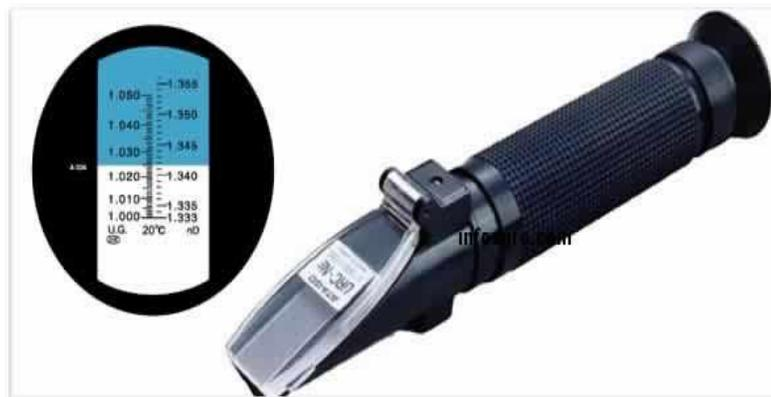
Figura N°32 Refractómetro portátil MODELO BX-50 VEE GEE
