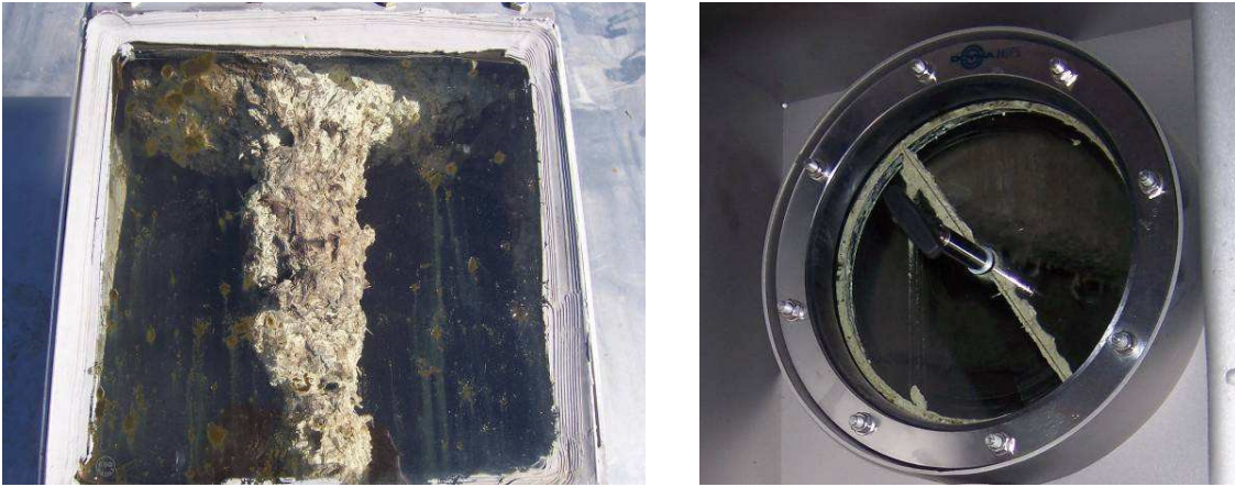
Figura 13.1.1.1. Azufre Elemental, resultado de Desulfuración dentro del Digestor (RUTZ 2007).
