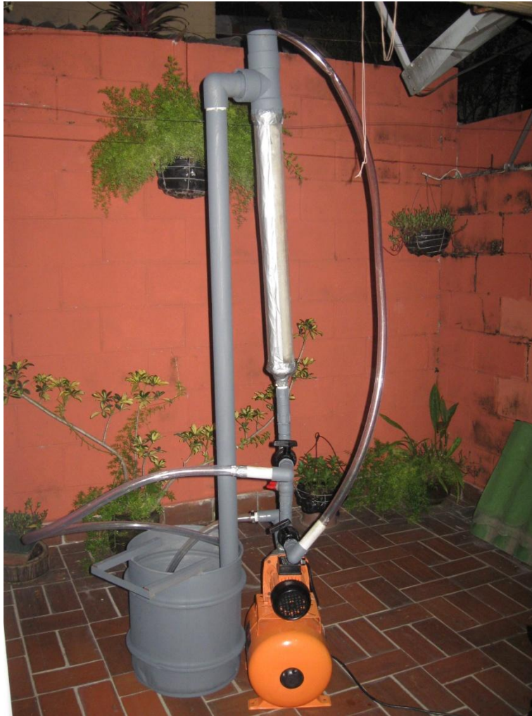
Figura 2.14 Construcción de equipo de lecho empacado para pruebas de flujo de fluidos a través de lecho fijo.
