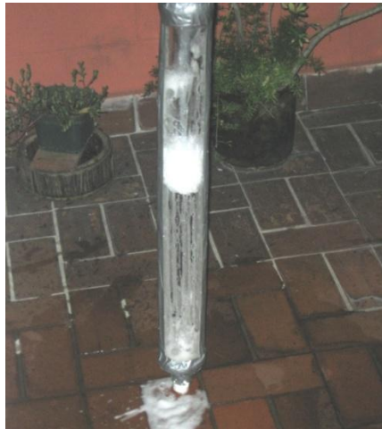
Figura 2.20 Lavando columna con agua y detergente
