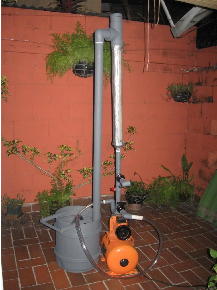
Figura 2.13 Construcción de equipo de lecho empacado para pruebas de flujo de fluidos en lecho fluidizado.
