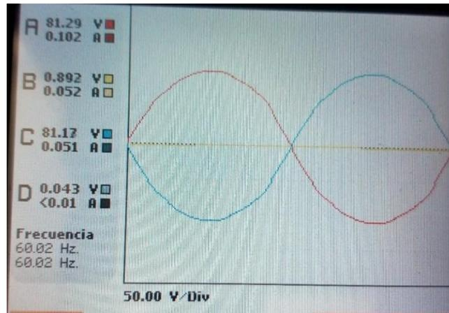
*Imagen 5.5 Forma de onda del voltaje en el primario de los transformadores antes de la condición de saturación utilizando circuito delta – estrella con capacitancia de 3.0  $\mu$ F*
