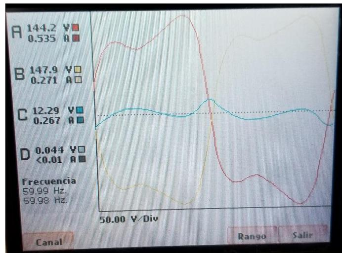
*Imagen 5.7* Forma de onda de tensión en el primario en condición de saturación para el circuito delta – estrella con  $3.0\mu F$ .
