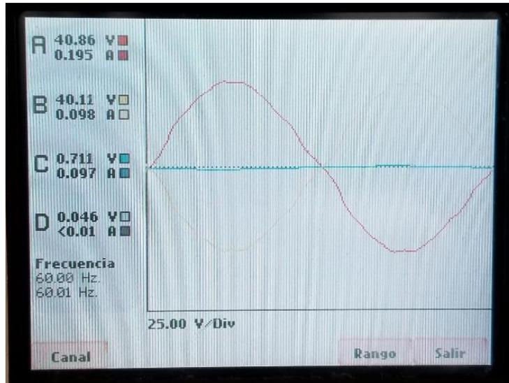
*Imagen 5.10 Forma de onda de voltaje en el primario conexión estrella – delta con capacitancia de  $3.0\mu\text{F}$ .*
