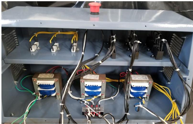
*Imagen 4.3 Distribución interna de los componentes del módulo.*
