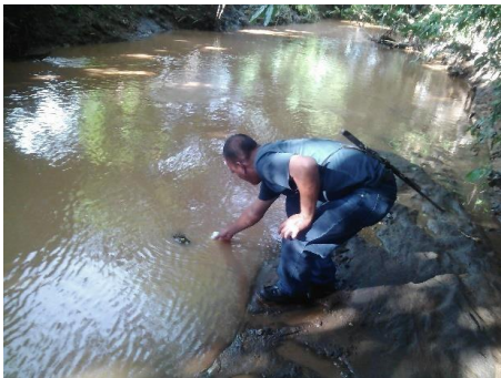
Anexo 33. Toma de muestras de agua para análisis microbiológico y físico químico en río Pululuya
