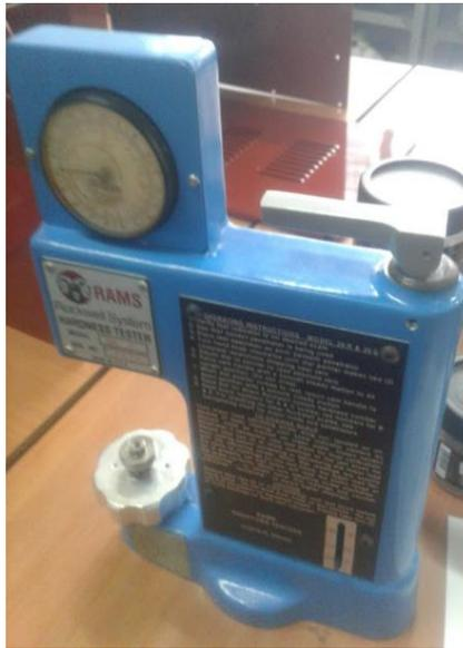
Fig. 2.17. Máquina de ensayo de dureza Rockwell de la Escuela de Ingeniería Mecánica de la Universidad de El Salvador.
