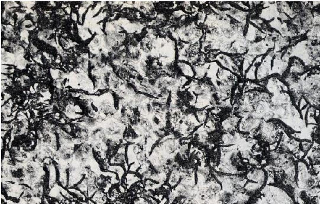
Fig. 3.2. Microestructura de hierro gris fundido x500. Hojuelas gráficas en una matriz perlítica con una pequeña cantidad de ferrita (áreas blancas) atacada químicamente con nital al 2%. Tomada de (Avner,1988)
