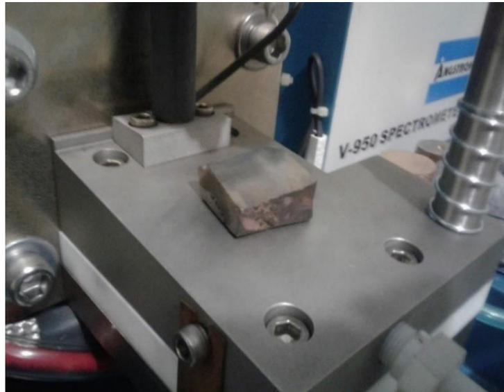
Fig. 2.6. Muestra colocada sobre el electrodo de chispeo. Fotografía tomada en el laboratorio de espectrometría de Metalúrgica Sarti.
