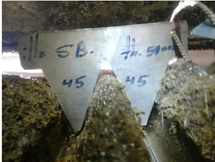
Fig. 3.13. Plantilla verificadora de desgaste en maza superior del molino 6. Fuente: Ingenio El Ángel
