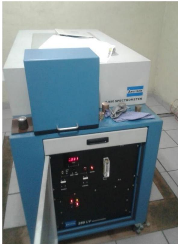
Fig. 2.3. Fotografía del espectrómetro de emisión óptica por chispa modelo Angstrom V-950 del laboratorio de espectrometría de Metalúrgica Sarti.
