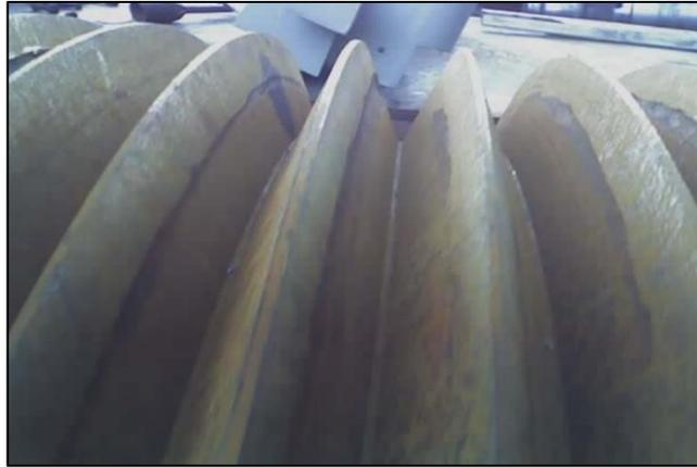
Fig. 1.7. Rayado típico de maza de molino de caña. Fotografía tomada de una maza maquinada del Ingenio El Ángel.
