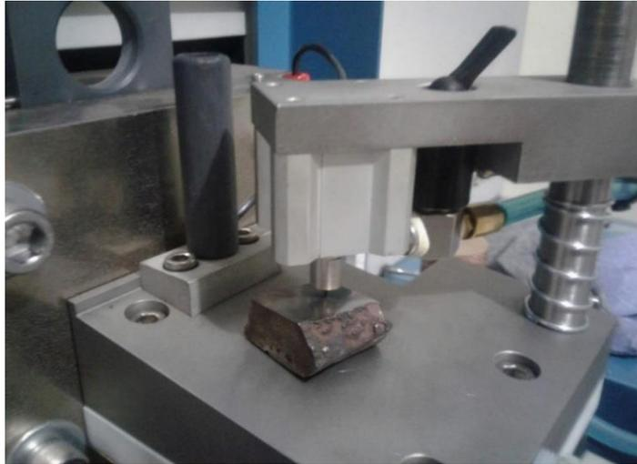
Fig. 2.7. Posicionamiento del brazo orientable sobre la muestra a analizar. Fotografía tomada en el laboratorio de espectrometría de Metalúrgica Sarti.
