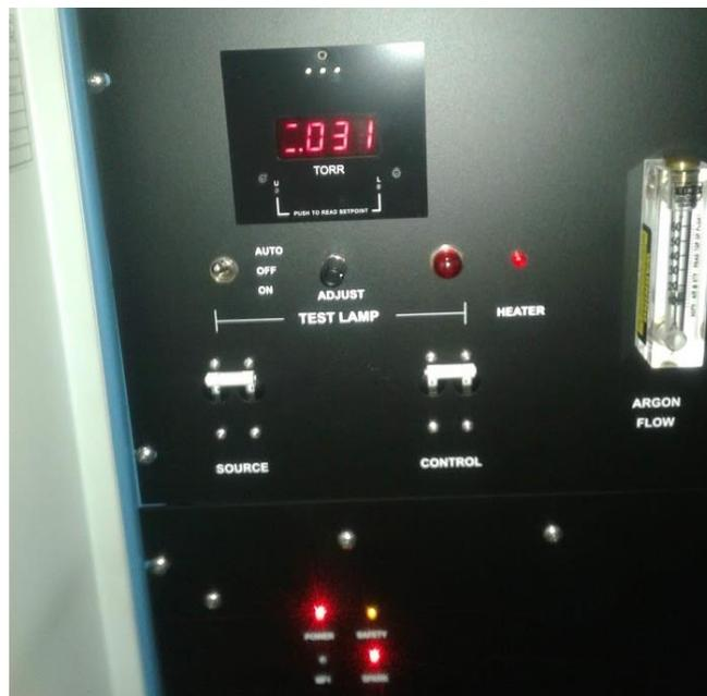
Fig. 2.4. Tablero de control del espectrómetro del laboratorio de espectrometría de Metalúrgica Sarti
