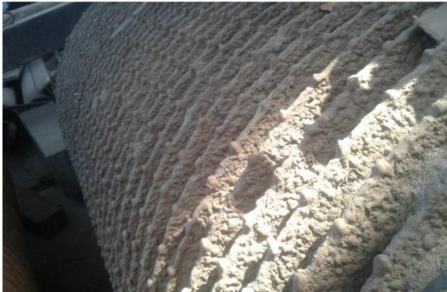
Fig. 1.10. Rugosidad típica deseada en los laterales de los dientes de las mazas. Fotografía tomada de una maza del Ingenio El Ángel.
