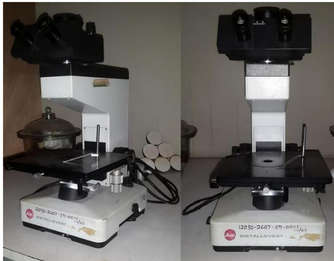
Fig. 2.11. Microscopio Óptico Metallovert Leitz de la Escuela de Ingeniería Mecánica de la Universidad de El Salvador. Fuente propia.
