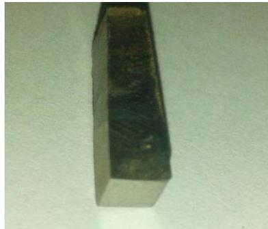
Fig. 2.10. Una de las muestras en estudio cortada, lijada y pulida de la cara inferior.
