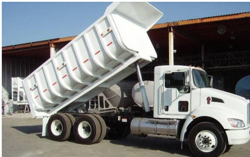
Imagen 32: Camión de volteo torton, de gran capacidad.
