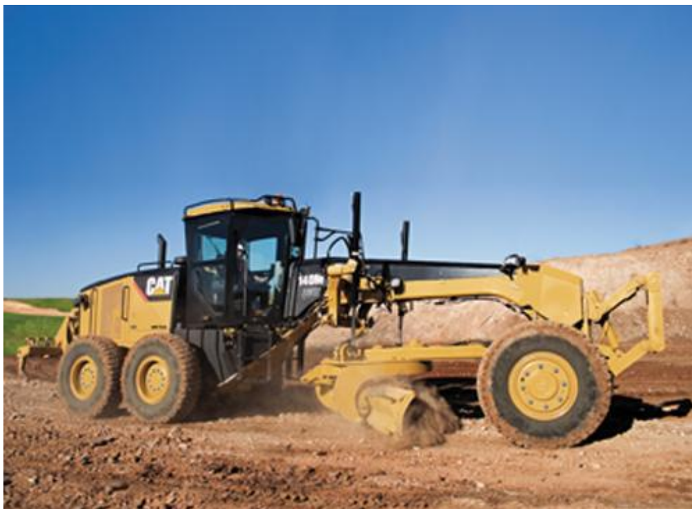
Imagen 19: Motoniveladora, usada para llevar la superficie del terreno al nivel deseado.
