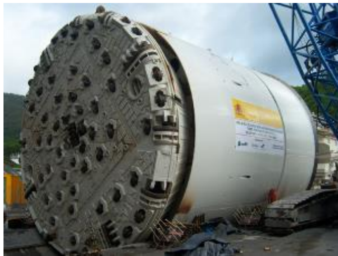
Imagen 73: Máquina excavadora de túneles.
