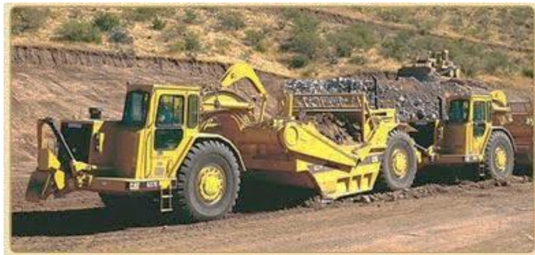
Imagen 18: Motoescrepa de tiro y empuje.
