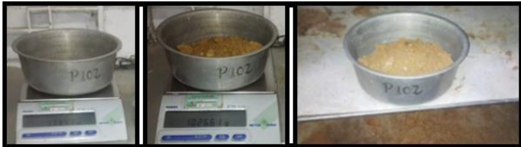
Imagen 88: toma del peso húmedo y seco de la muestra extraída en la excavación.
