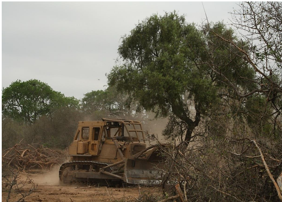
Imagen 12: Tractor realizando tala y roza simultáneamente.
