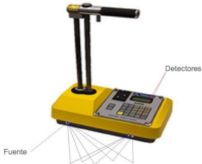
Imagen 89: Determinación de la densidad por retro-dispersión.
