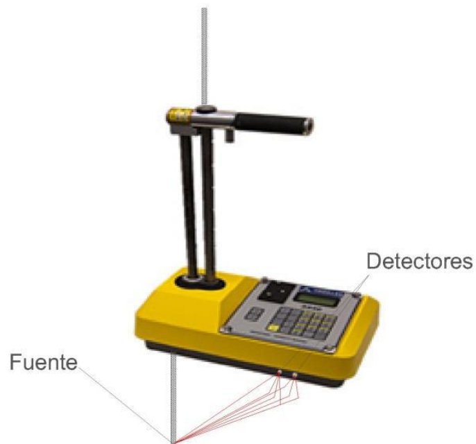
Imagen 90: Determinación de la densidad por medio de transmisión directa.
