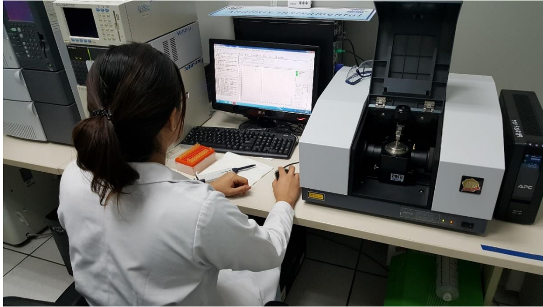
FIGURA N° 39: Lectura de muestra de pan dulce artesanal en espectrofotómetro infrarrojo con sistema de unidad de reflectancia total atenuada.
