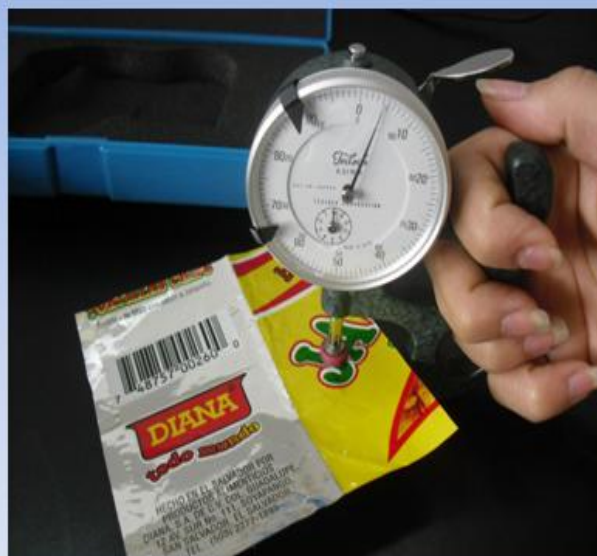
Descripción: Medición de la prueba de calibre para una probeta de muestra de MX-D.
