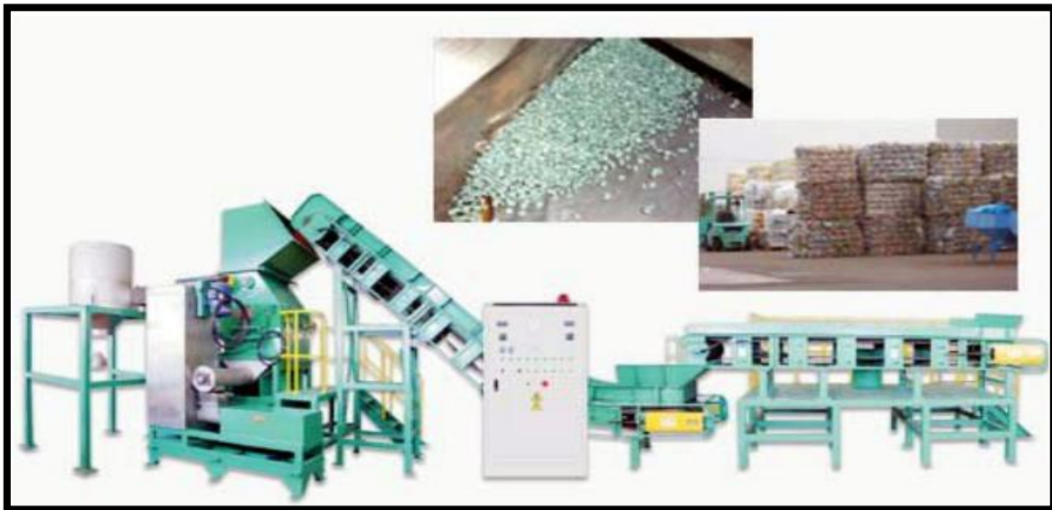
Ilustración A. 2 Esquema del proceso de obtención gránulos de PP.
