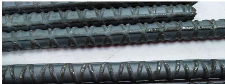
Figura No. 94 Barras No. 4 (1/2”) grado 40 (280 MPa), elaborados por la empresa B. Fuente: Propia.
