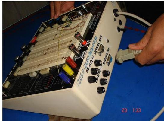
**Figura A. 1** Conexión del cable de comunicación serial
