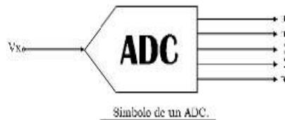
**Figura 3. 4** Representación simbólica de un convertidor analógico-digital
