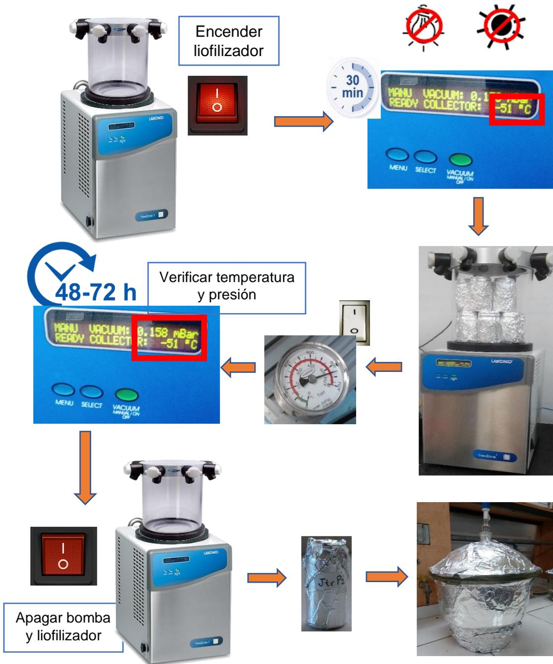
Figura N°40. Esquema de proceso de liofilización de los extractos acuosos.
