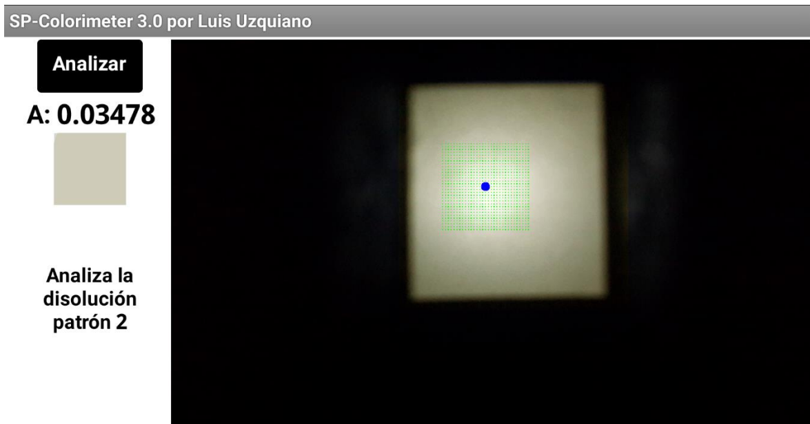
Figura 15: Paso 3.1. La fotografía del segundo punto de la curva de calibración se muestra en pantalla.
