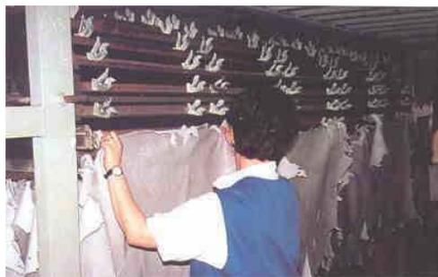
Figura III-8: Secado de Pinzas
