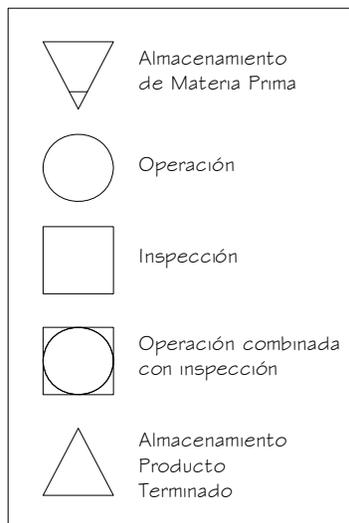
Además de los símbolos anteriores, se utilizan líneas verticales y horizontales. Las verticales indican el flujo general del proceso al realizar el trabajo, las horizontales entrando a la línea de flujo indican los materiales comprados. En la P+L se necesita representar las salidas de los procesos, para lo cual se utilizarán líneas horizontales saliendo de la línea de flujo. Lo dicho anteriormente puede observarse claramente en la siguiente figura:
