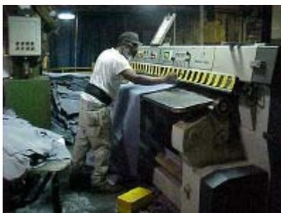
Figura III-3: Operación de Dividido de la piel en la máquina divididora
