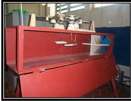
**Figura IV.1** Vista de la distribución de las bandejas y accesorios en el secador, para elaboración curvas de secado.
