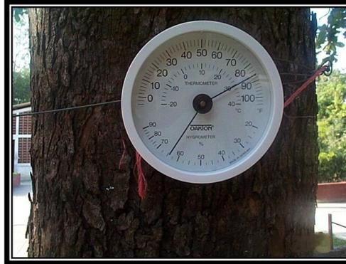
**Figura 7.6** Medidor de Humedad Relativa y temperatura ambiente
