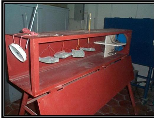
**Figura 7.17** Vista de la distribución de las bandejas y accesorios en el secador
