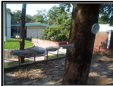
**Figura 7.7** Distribución de muestras en la zona de secado.
