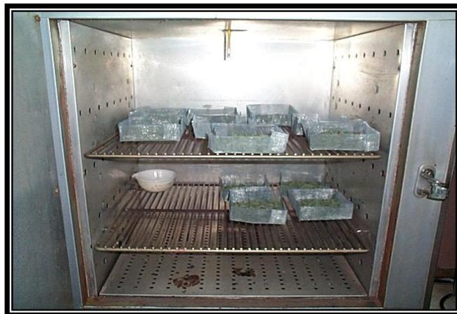
**Figura 7.1.** Distribución de bandejas en el interior de la estufa
