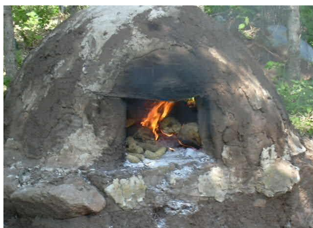
FIGURA 7.4 (B) CALENTAMIENTO DEL HORNO PARA ELABORAR EL CARBÓN ARTESANAL (Fuente: Propia)
