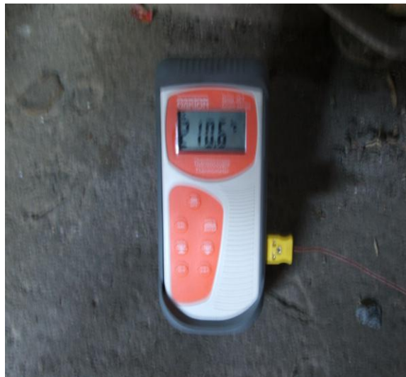
FIGURA 8.4 (B): TERMÓMETRO DIGITAL PARA EL MONITOREO DE TEMPERATURAS HASTA DE 1200 °C. (Fuente: Propia).
