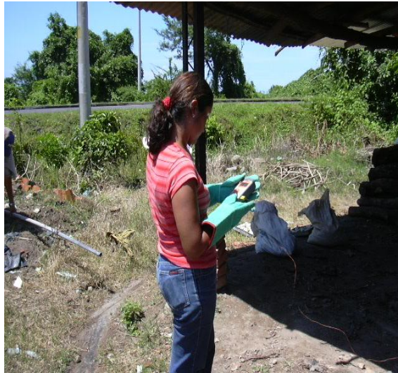
FIGURA 8.4(A): MONITOREO DE TEMPERATURA DE HORNO DE FABRICACIÓN DE LADRILLO (Fuente: Propia)
