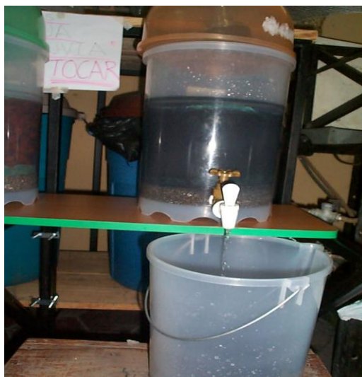
FIGURA 8.14 ARRASTRE DE ARENA A TRAVÉS DEL EFLUENTE DE LA COLUMNA.
