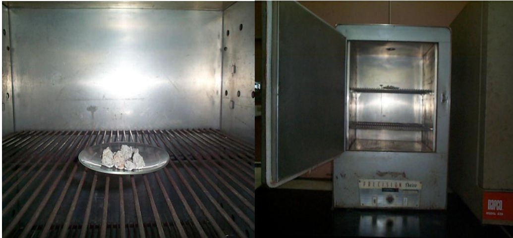
FIGURA 9.1: SECADO DE LA MUESTRA DE PERLITA EN LA ESTUFA. (Fuente: Propia)
