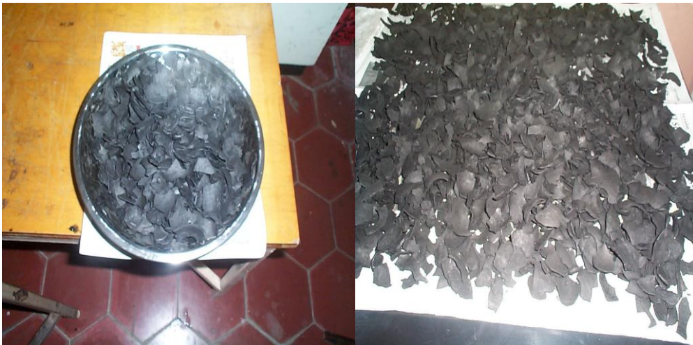
FIGURA 7.3 SECADO AL AMBIENTE DEL CARBÓN ACTIVADO ARTESANAL DESPUÉS DE LA ACTIVACIÓN. (Fuente Propia)
