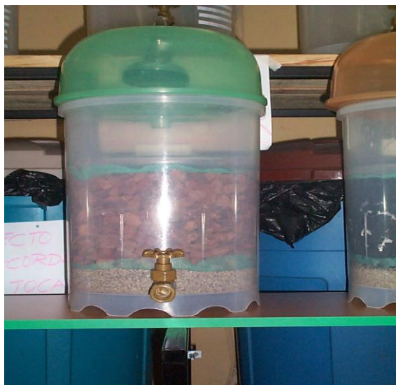
FIG. 8.11 COLUMNA DE ADSORCIÓN YA PREPARADA. (Fuente: Propia.)
