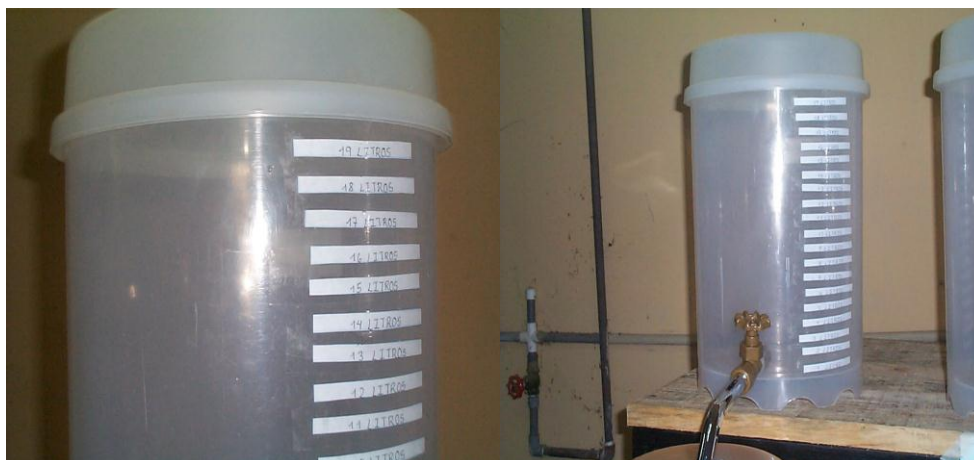
FIG. 8.15 TANQUES CALIBRADOS. (Fuente: Propia.)
