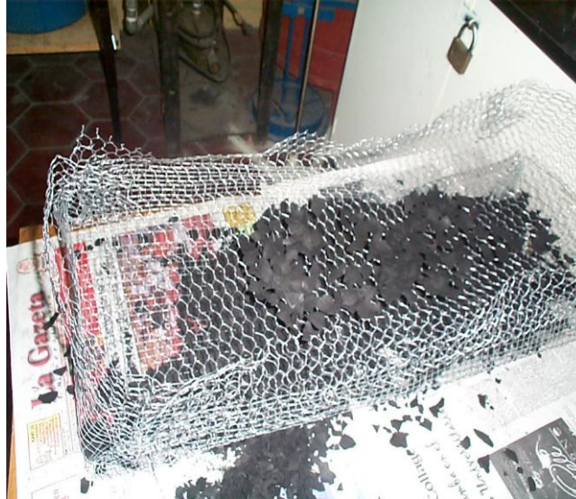
FIGURA 8.7 (A): TAMIZADO DE CARBÓN ACTIVADO ARTESANAL (Fuente: Propia)
