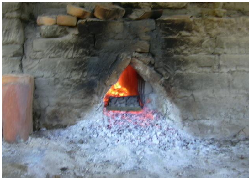
FIG. 8.3: CALCINACIÓN DE LA PERLITA (SE REALIZÓ EN EL INTERIOR DONDE COLOCAN LA LEÑA DEL HORNO PARA LA ELABORACIÓN DE LADRILLO ARTESANAL)
