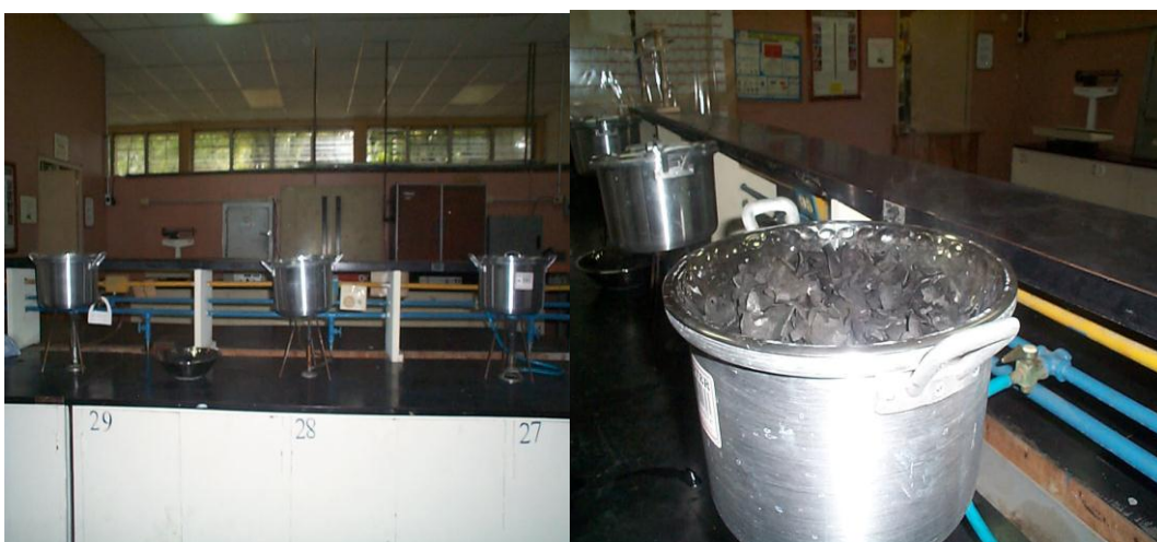
FIGURA 7.2 ACTIVACIÓN DE CARBÓN ARTESANAL A NIVEL DE LABORATORIO (Fuente Propia)
