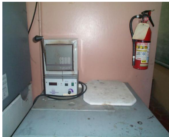
FIGURA 7.1: MUFLA UTILIZADA PARA PRUEBAS A NIVEL DE LABORATORIO CON EL COCO TIERNO Y MADURO. (Fuente: Propia).
