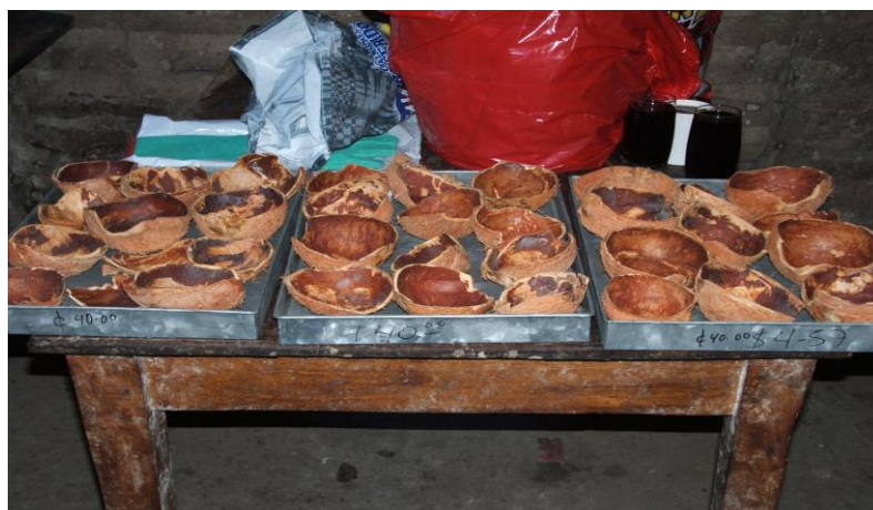
FIGURA 7.5 (B): CONCHA DE COCO SOBRE LAS BANDEJAS ANTES DE LA INTRODUCCIÓN AL HORNO PARA SU CARBONIZACIÓN. (Fuente: Propia)
