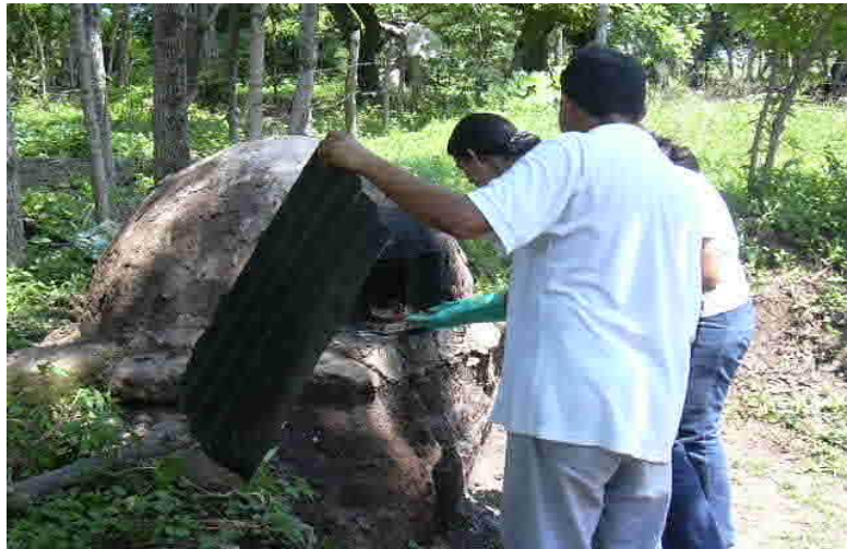
FIGURA 7.6 INTRODUCCIÓN DE BANDEJAS CON LA CONCHA DE COCO PARA LA CARBONIZACIÓN (Fuente: Propia)
