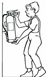
Figura 27. Descolgar el extintor
