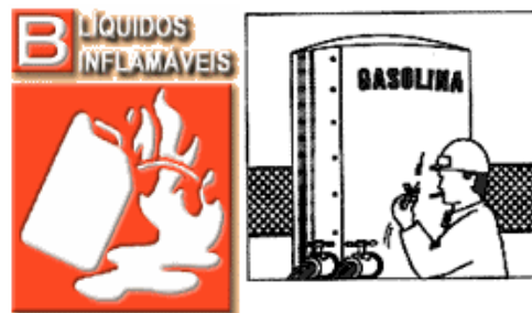
Figura 14. Líquidos inflamables como gasolina producen incendio Clase B
