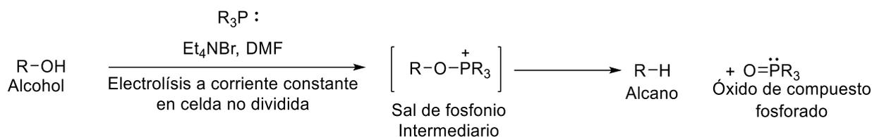
**Figura 23. Esquema general de la desoxigenación electroquímica de Ohmori**
