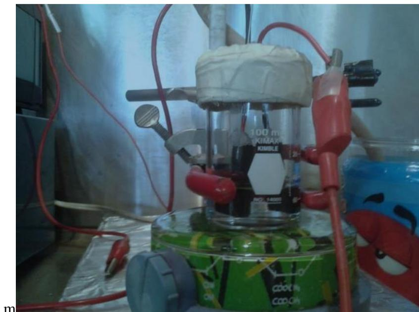
**Figura 24. Celda no dividida improvisada en el laboratorio.**
