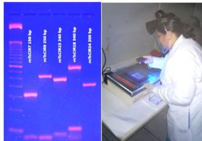
6. Visualización de las bandas de los productos de PCR amplificados en el Transiluminador de luz ultravioleta.
