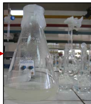
Agregar 100ml de agua libre de \text{CO}_2 . Disolver
