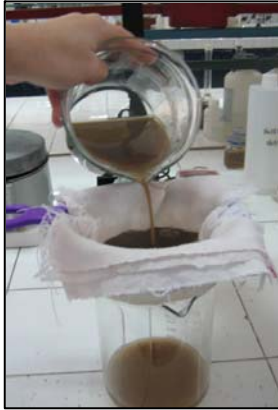
1ª Filtración con manta gruesa
