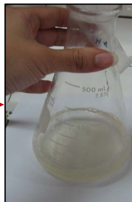
Agregar 20ml de HCl 0.5 N VS, agitar hasta desaparecer color rosa
