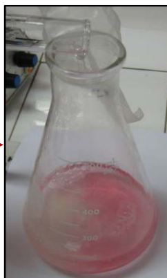
Agregar 20ml de NaOH 0.5 N. Tapar agitar y dejar reposar 15 min
