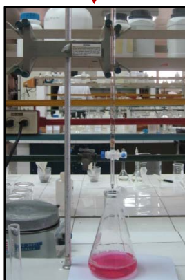
Agregar 3 gotas de fenolftaleína y valorar con NaOH 0.5 N VS hasta obtener coloración rosa débil
