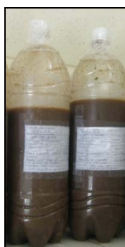
Figura 3.2 Agua miel procedente de desmucilagado mecánico
