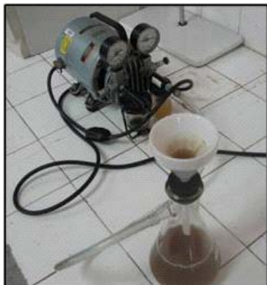
3ª Filtración con papel Whatman 41 y bomba de vacío
