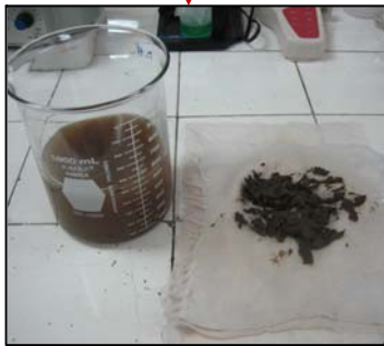
Separación de solidos en manta gruesa
