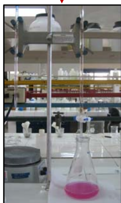
Agregar fenolftaleína y titular con NaOH 0.5 N VS
