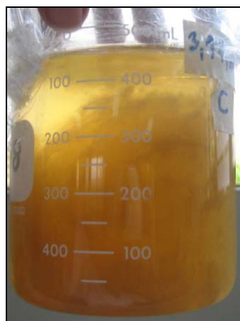
Figura 3.3 Coágulo de pectina obtenida experimentalmente
