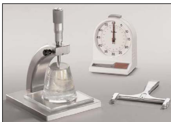
Figura 2.6 Ridgelímetro (para el método USA-SAG)
