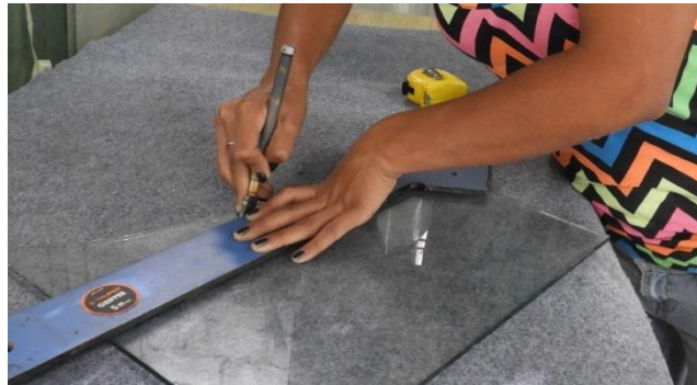
Ilustración 42. Ilustración de como marcar el vidrio para el manual, Rony Hernández 2017
