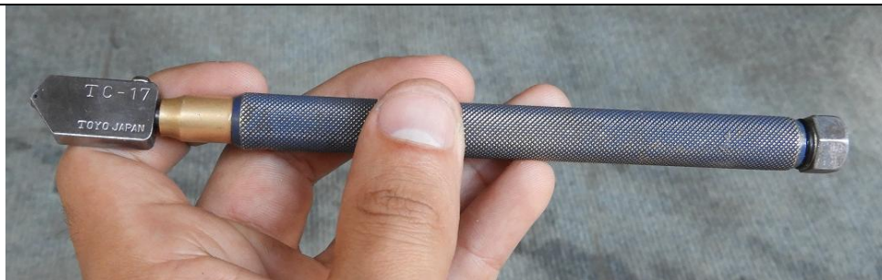
Ilustración 36. Ilustración del cortador toyo para el manual. Rony Hernández, 2018
