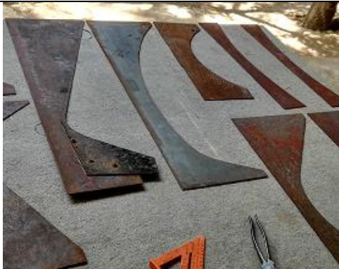
Ilustración 44. Ilustración de moldes de hierro usado en termoformado para el manual. Rony Hernández 2017
