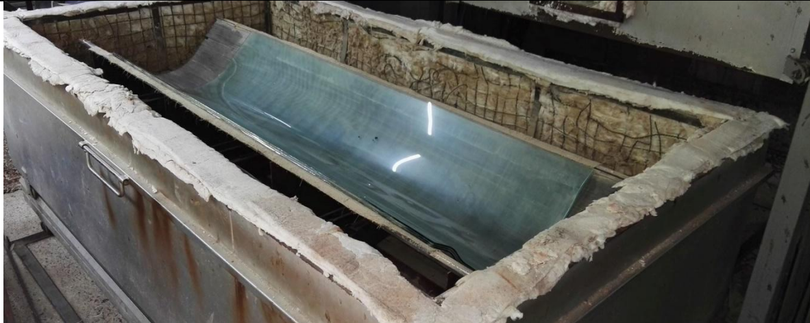
Ilustración 50. Ilustración de extracción del vidrio del horno para el manual. Rony Hernández 2017
