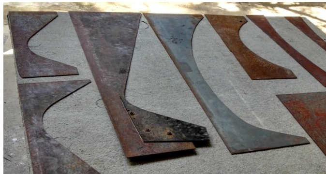
Ilustración 22. Perfiles para moldes de Hierro, Rony Hernández 2018
