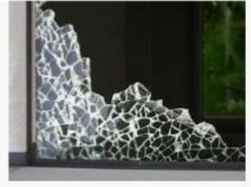
Ilustración 9. Vidrio templado utilizado en automotriz
