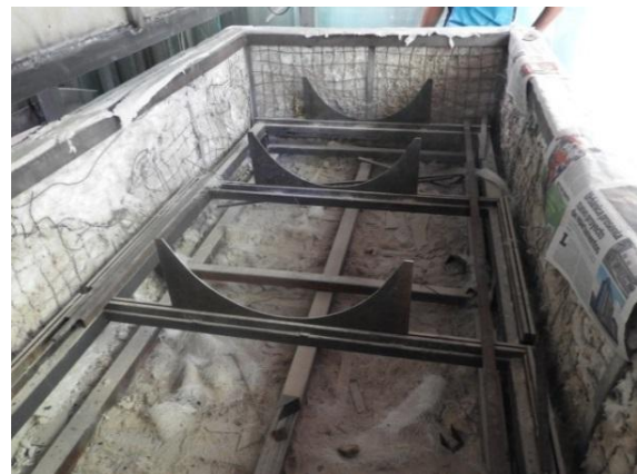
Ilustración 23. Moldes introducidos en el horno para lograr las curvas deseadas mediante el termoformado. Rony Hernández, 2017
