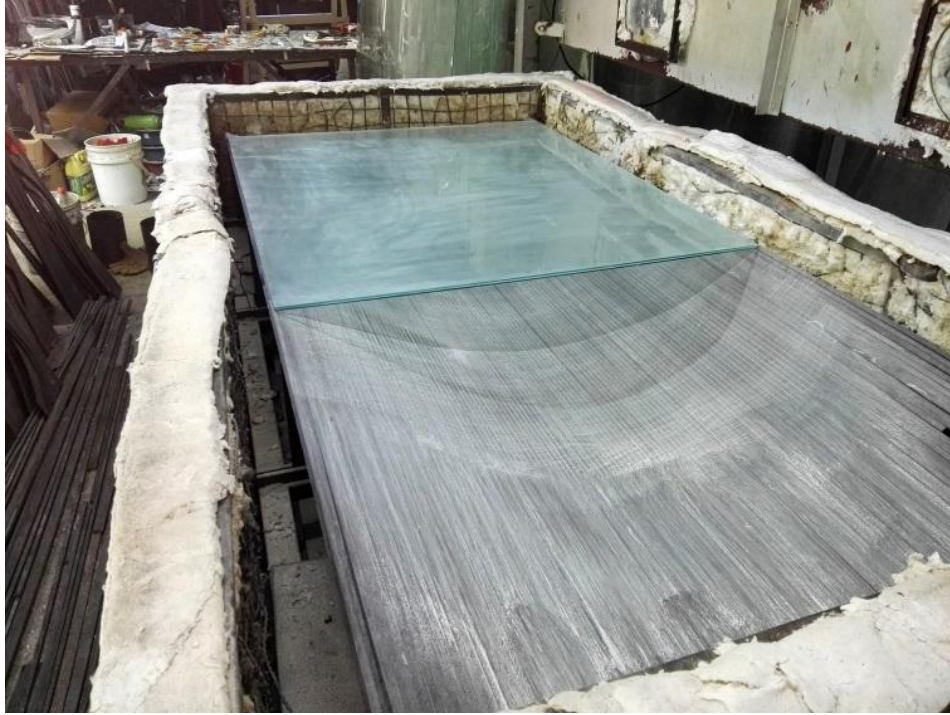
Ilustración 48. Ilustración de la preparación de vidrio en el horno para el manual. Rony Hernández 2017
