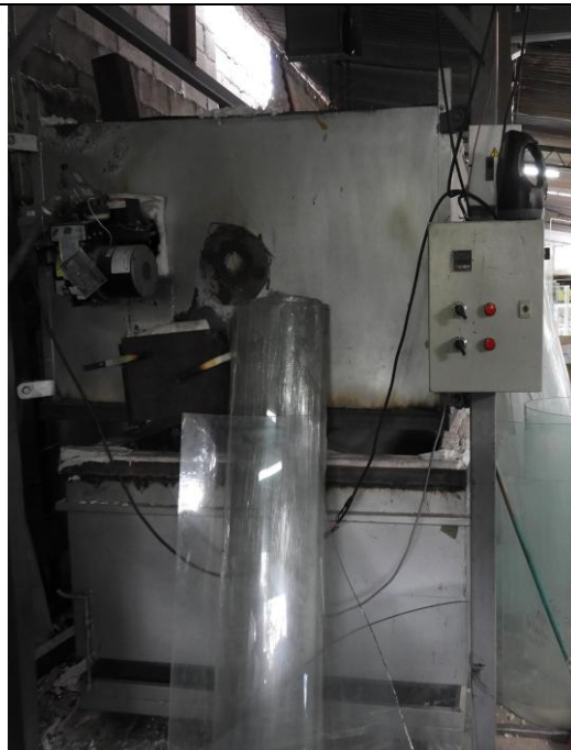
Ilustración 39. Ilustración del horno de termoformado en el taller Vidrio Curvo para el manual. Rony Hernández, 2018
