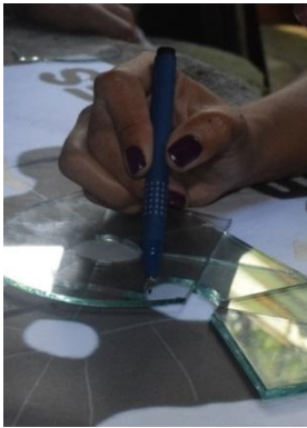
Ilustración 41. Ilustración de como marcar el vidrio para el manual, Rony Hernández 2017
