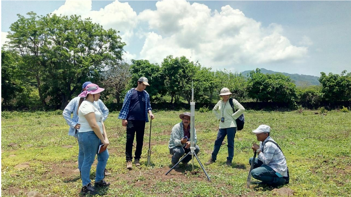
Figura 2.6 Toma de datos de prueba de infiltración en punto Pinf15-AS realizada en mayo de 2018.
