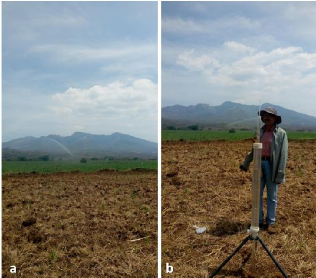
Fotografía 11. (a) Vista de cultivo Arundo Donax en Hacienda Santa Marta en caserío San Francisco. Se observa uno de los sistemas de riego utilizado. (b) Realización de prueba de infiltración en punto PInfl-Apolinario Serrano , desarrollada en uso de suelo caña de azúcar
