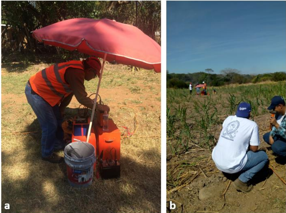
Fotografía 13. Desarrollo de tomografías eléctricas en la zona de estudio. (a) MSc. Luis castillo revisa conexión del equipo ABEM Terrameter SAS 1000. (b) Integrantes del grupo de investigación en hidrología conectan electrodos y toman datos con GPS.
