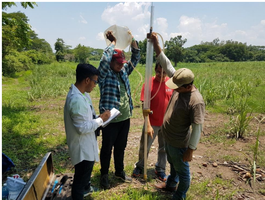
Fotografía 12. Prueba de infiltración PInfl4- Hacienda Santa Marta , desarrollada sobre uso de suelo Arundo Donax .
