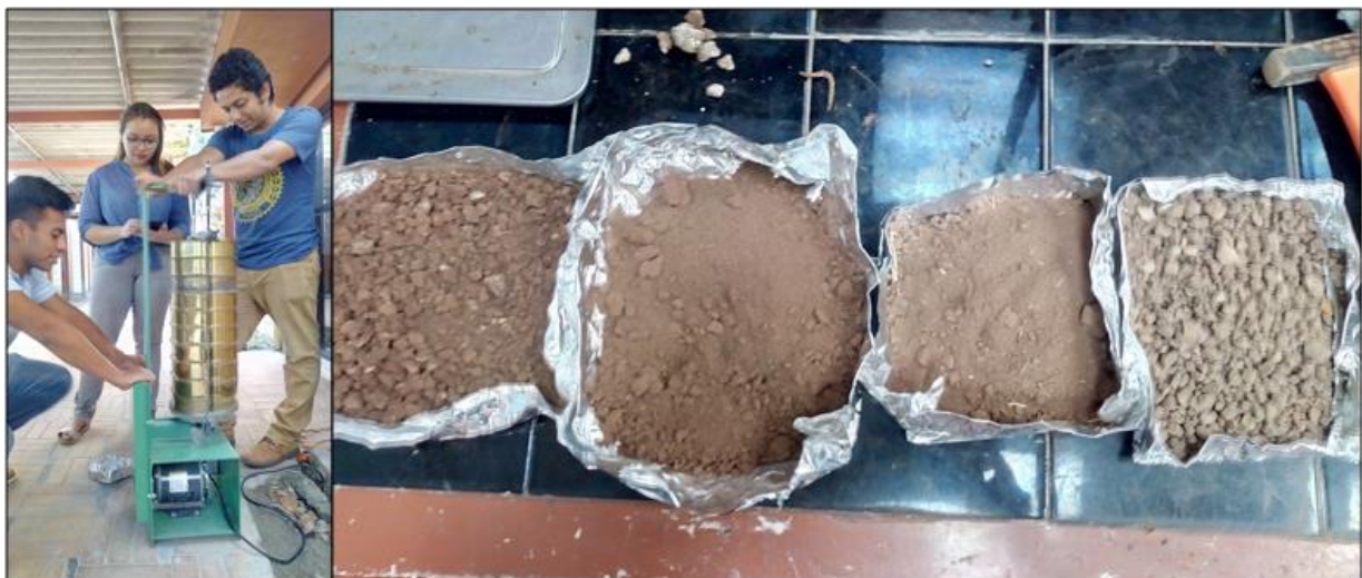
Figura 2.10 Tratamiento de muestras de suelo tomadas en campo para construcción de curva granulométrica.
