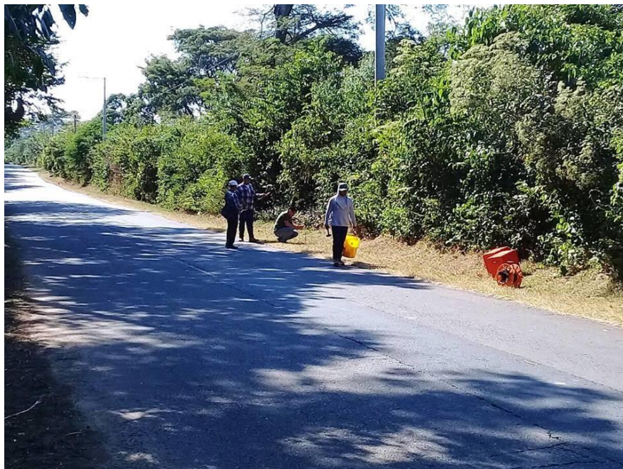
Figura 2.9 Colocación de electrodos y cables para la toma de datos con el equipo ABEM Terrameter SAS 1000. Tomografía 1 “TOMO 1: EL LIBANO 1”.
