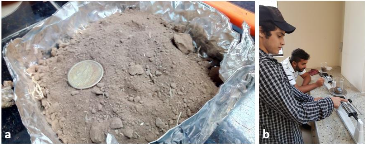
Fotografía 15. (a) Preparación de muestras de suelo para secado en horno. Las muestras de suelo se han tomado de la zona donde se han realizado las pruebas de infiltración. (b) Estudiantes pesan el material retenido por cada tamiz en las instalaciones del laboratorio de física.
