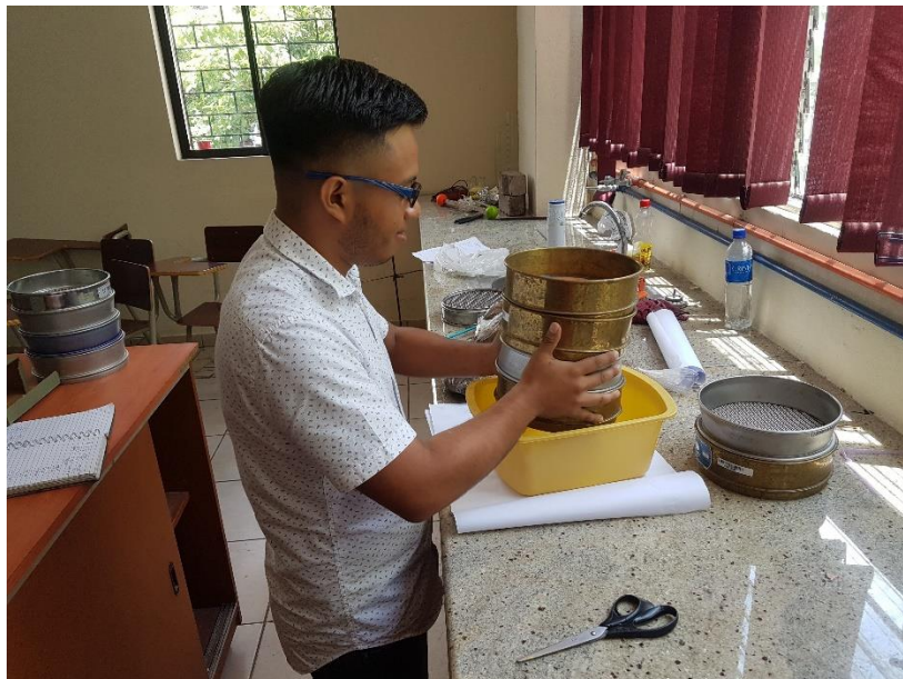
Fotografía 14. Procesamiento de muestras de suelo en laboratorio para la obtención de curvas granulométricas que permitan estimar la textura del suelo.
