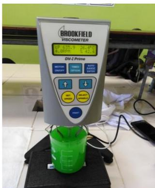
Figura N° 26. Viscosidad del Jarabe de Benzoato de Sodio, tomada con viscosímetro Brookfiel DV-I Prime, Spindle S62.
