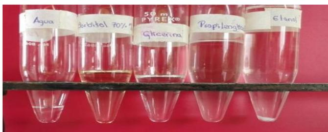
Figura N° 6. Resultados experimentales de la solubilidad del Benzoato de Sodio en diferentes disolventes.
