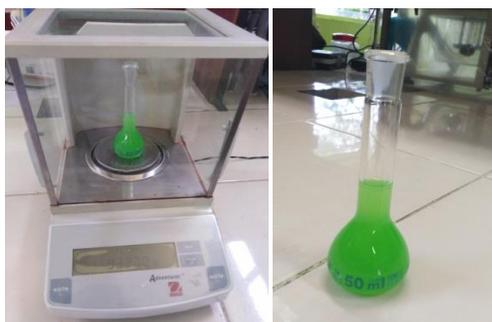
Figura N° 24. Determinación de densidad en Jarabe de Benzoato de Sodio a escala piloto.
