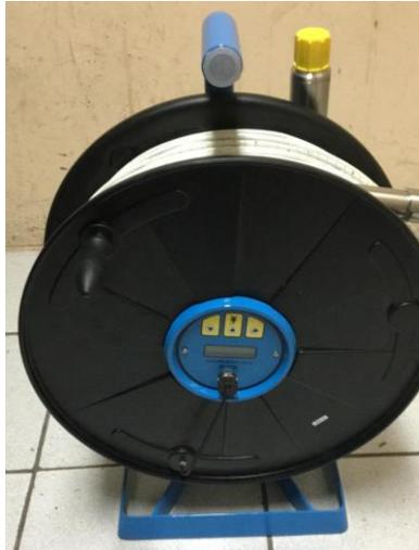
*Figura 2. 3: Sonda multiparámetro empleada en la medición de los parámetros hidrogeológicos (nivel estático, temperatura y conductividad eléctrica del agua)*
