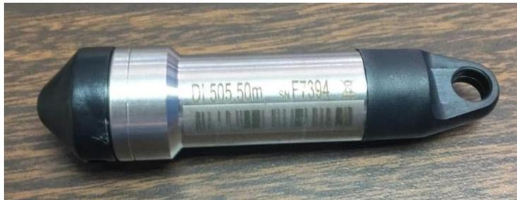
*Figura 2. 2: Equipo utilizada para medición de los parámetros hidrogeológicos (nivel estático, temperatura y conductividad eléctrica del agua) (SNF7304)*
