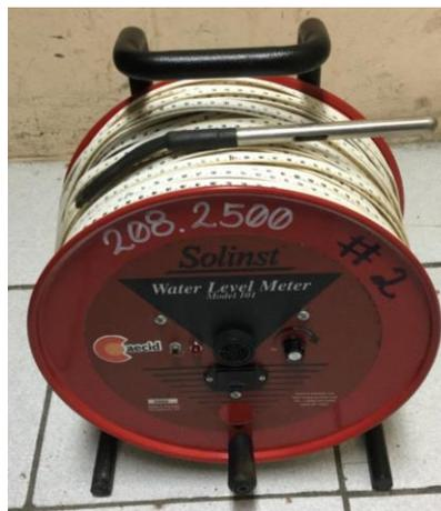
*Figura 2. 4: Sonda que mide el nivel del agua en los pozos.*
