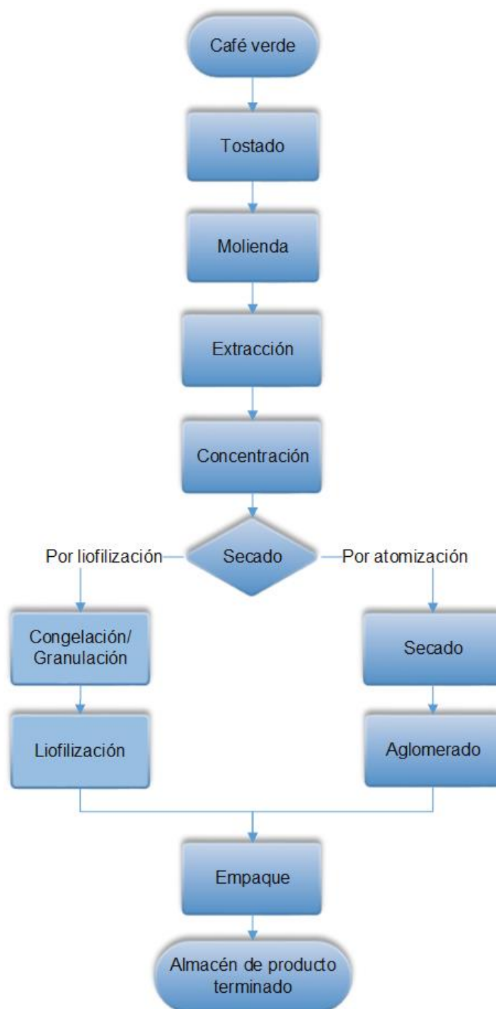
Figura N° 3. Diagrama de flujo de etapas de la producción de café instantáneo.
