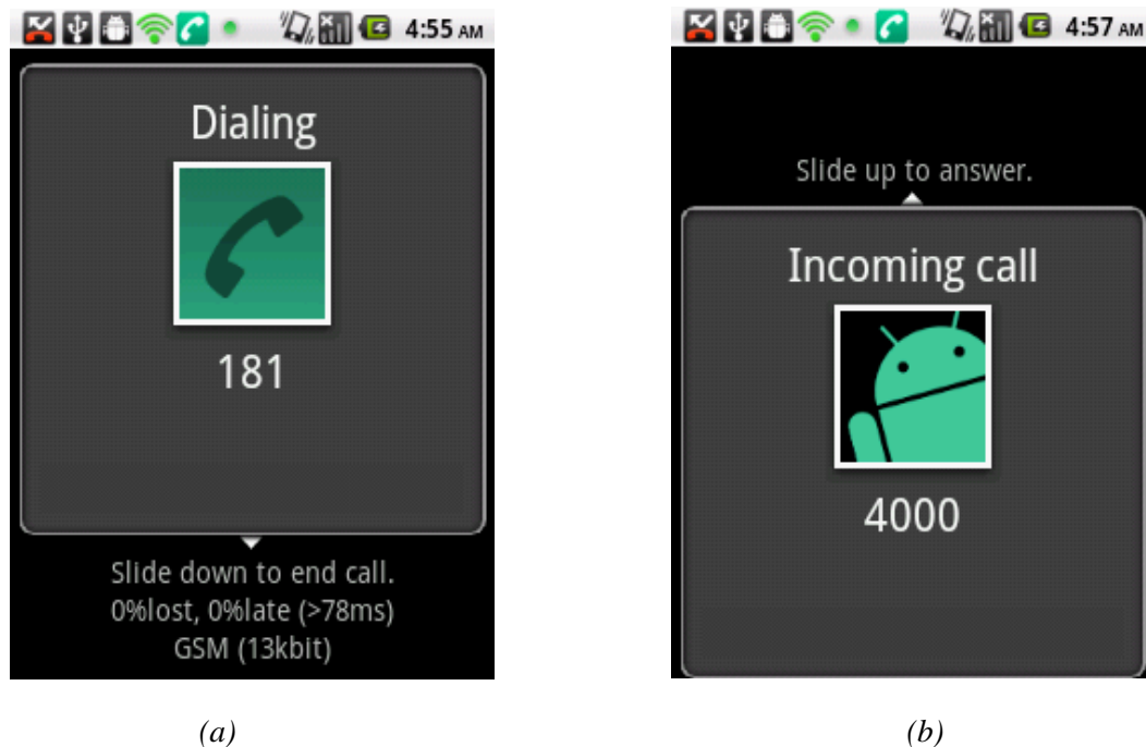
Figura 18. (a) Llamada realizada al Huawei U8150 según tabla 8, (b) Llamada entrante El Serval Project se basa en la idea de Village Telco para agregar un número telefónico a la capa de asignación de dirección SIP, que convierte los números marcados en direcciones SIP. Esto establece el contacto con el batphone que tenga la IP marcada, usando el mismo método que se ha utilizado en la red Mesh Potato.
