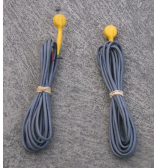
Figura 3.25 Sensores Térmicos con memoria interna para registrar datos por 28 días
