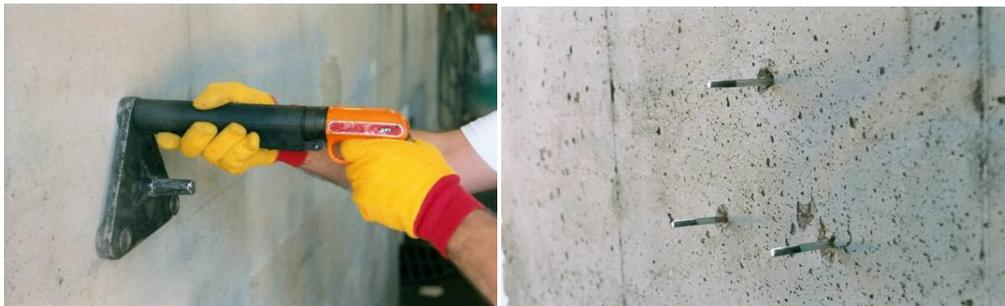
Figura 2.31 Equipo para el impulso de pines para la determinación
