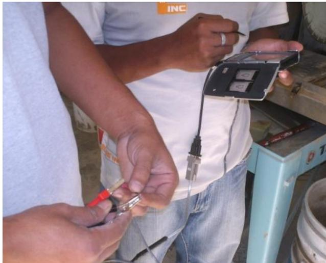
Figura 3.23 Se conectan los terminales de los sensores al dispositivo para registrar lecturas de temperatura
