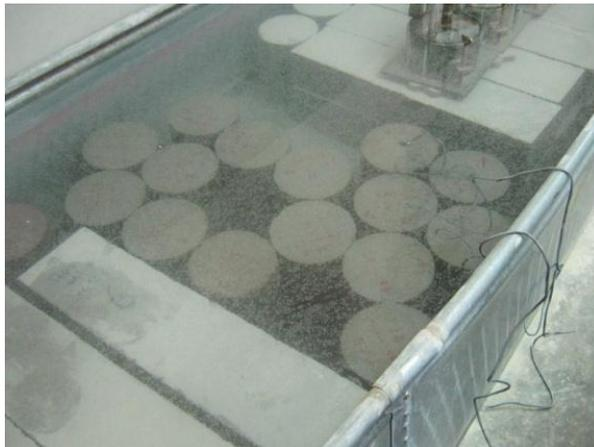
Figura 3.16 Curado de especímenes de concreto.
