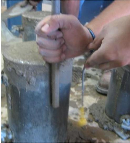
Figura 3.19 Se estima el centro de la altura del cilindro con la varilla rígida
