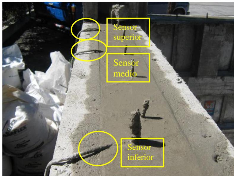
Figura 3.49: Sistema de paredes coladas con sensores embebidos
