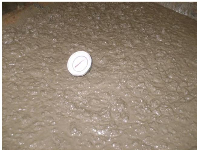
Figura 3.52: Ensayo de temperatura en el concreto fresco
