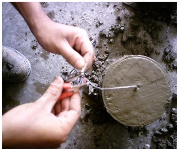
Figura. 3.34 Se conectan los clips del equipo a los sensores.
