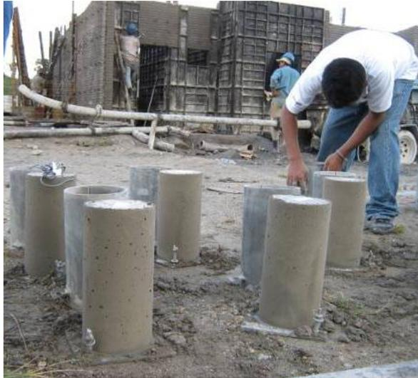
Figura 3.4 Desmoldado de especímenes al mismo tiempo del desmolado de la vivienda
