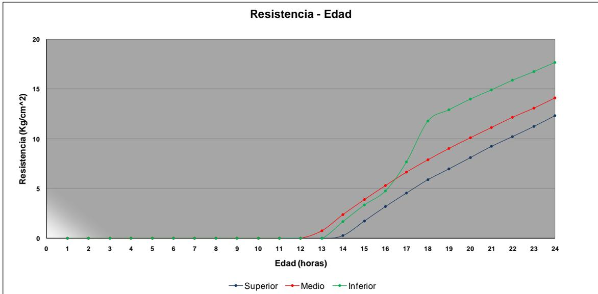
Figura 4.15 Gráfica de Resistencia – Edad para intervalos de 1 hora durante las primeras 24 horas
