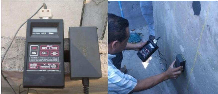
Figura 3.70. Equipo para detectar el acero de refuerzo
