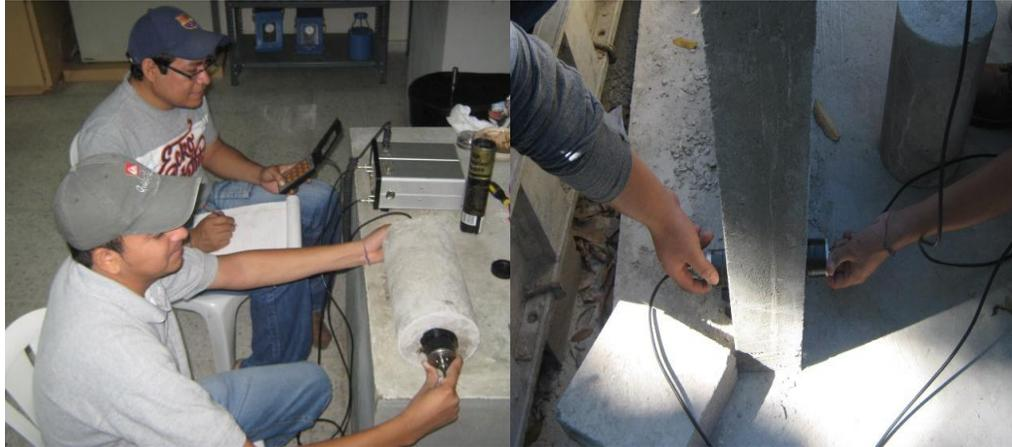
Fig. 3.66. Colocación de los transductores para la toma de lecturas.
