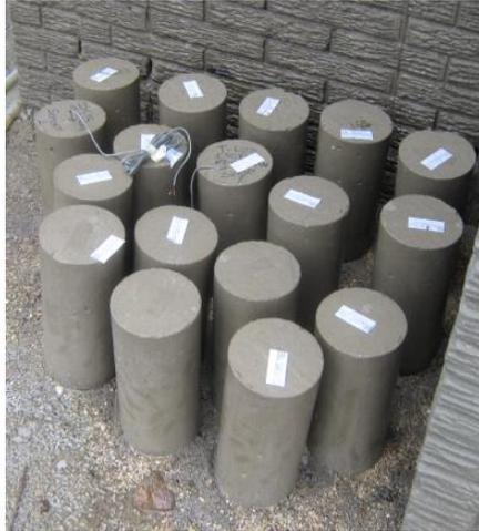
Figura 3.6 Curado en condiciones de campo
