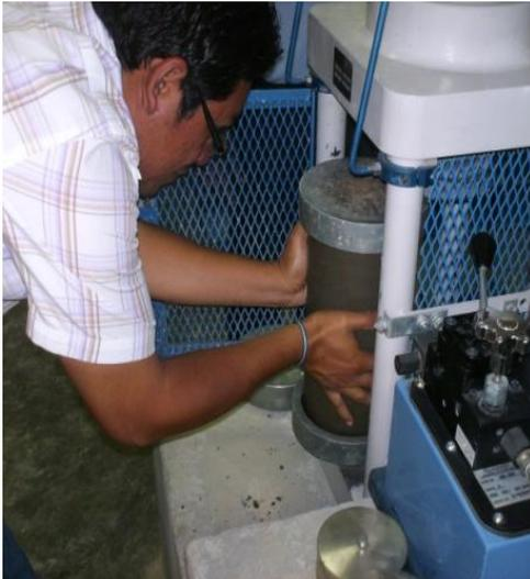
Figura 3.17 Ensayo de especímenes a la compresión
