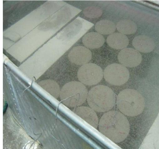
Figura 3.7 Curado en condiciones de laboratorio
