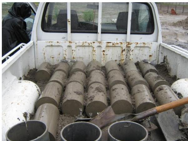
Fig.3.5 Desmoldado y transporte de especímenes 24 horas después de elaborados
