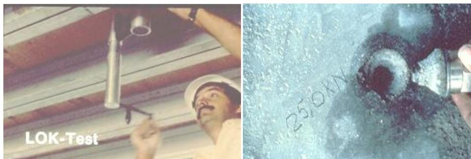
Figura 2.32 Colocación de dispositivo para la determinación de la resistencia mecánica del concreto por medio del ensayo de la adherencia.
