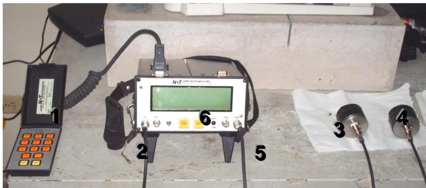
Fig. 3.63 Equipo utilizado en el ensayo de pulso ultrasónico.
