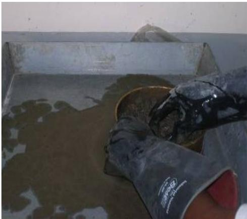
Figura 3.54: Tamizado del concreto por la malla No 4 para elaboración de los cubos
