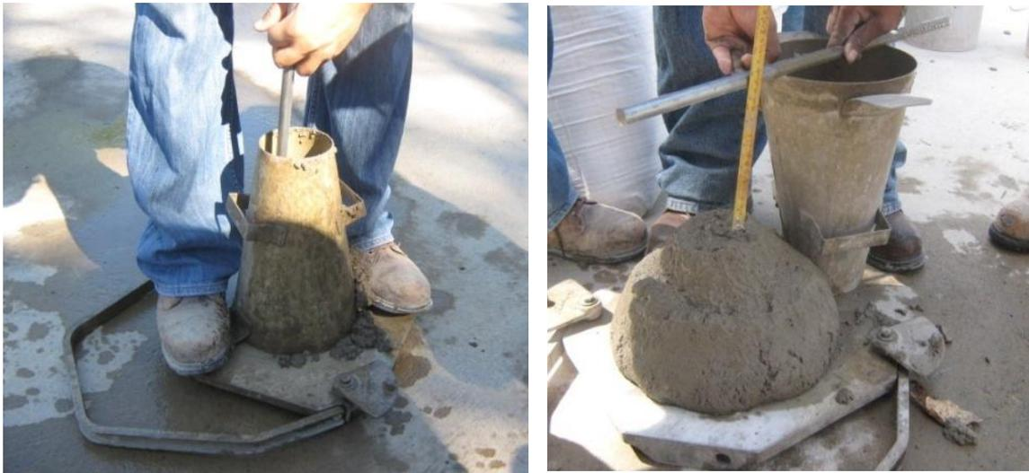
Figura 3.53: Ensayo de revenimiento de la mezcla
