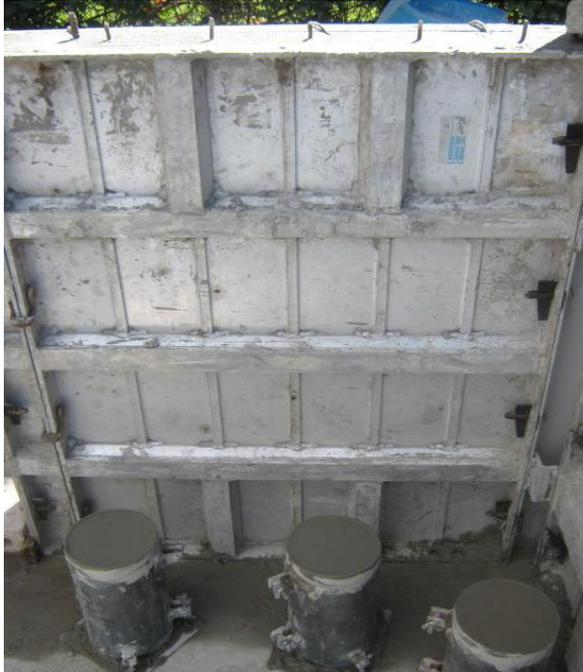
Figura 3.67: cilindros curados bajo las mismas condiciones de la pared
