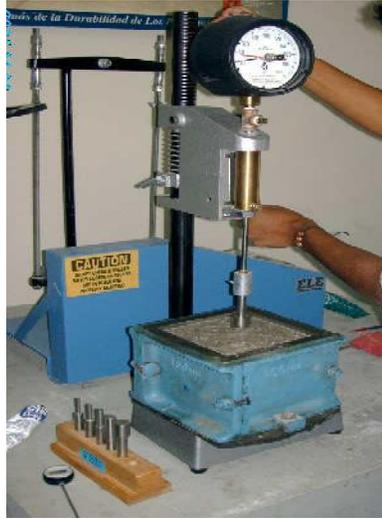
Figura 2.13: Ensayo de fraguado del concreto
