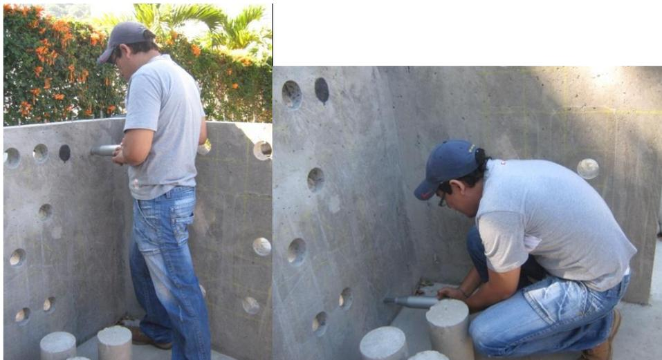
Figura 3.68: Ensayo de número de rebote en la pared a la altura superior e inferior
