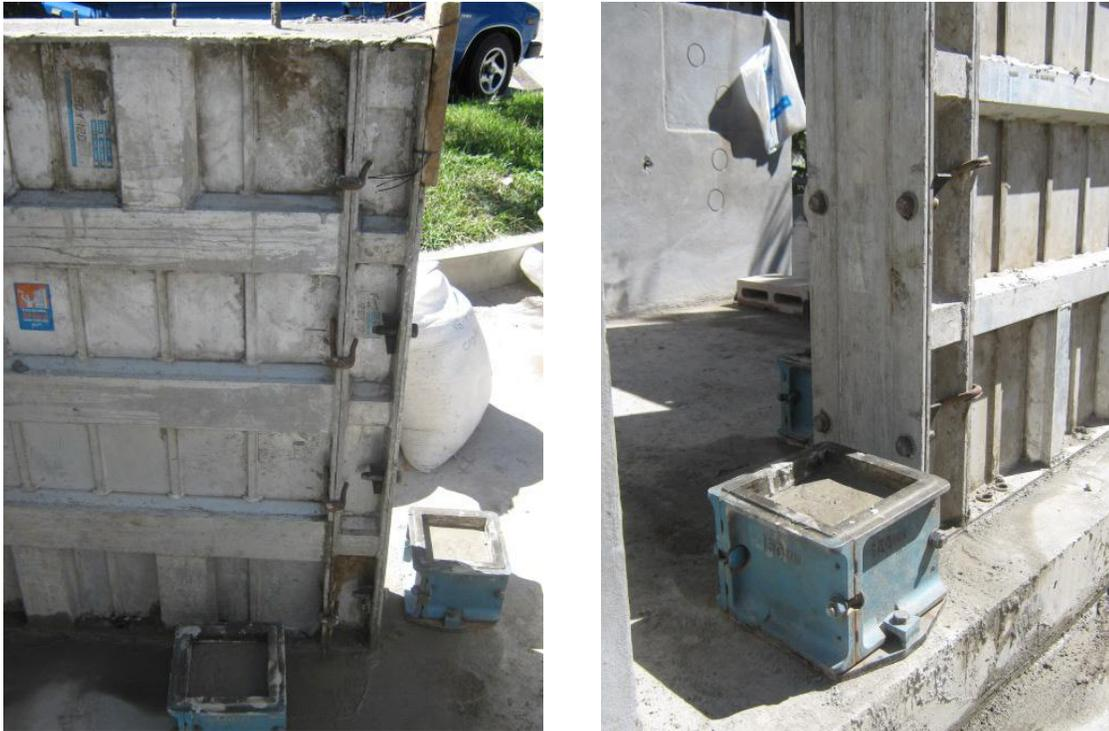
Figura 3.56: Especímenes bajo las mismas condiciones de la estructura
