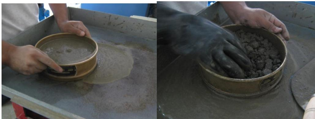
Figura 3.38 Tamizado de concreto por malla #4
