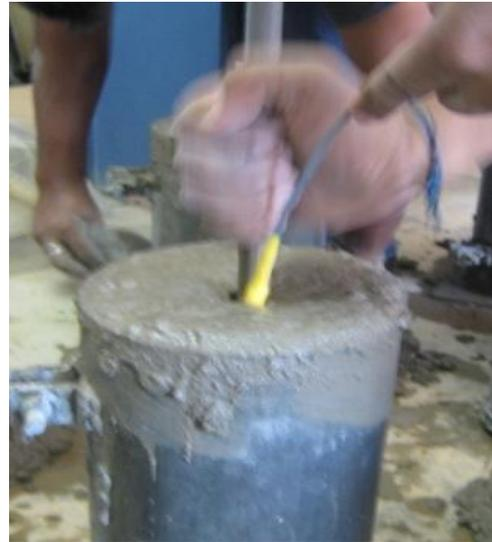
Figura 3.20 Se introduce la varilla hasta la altura media del cilindro
