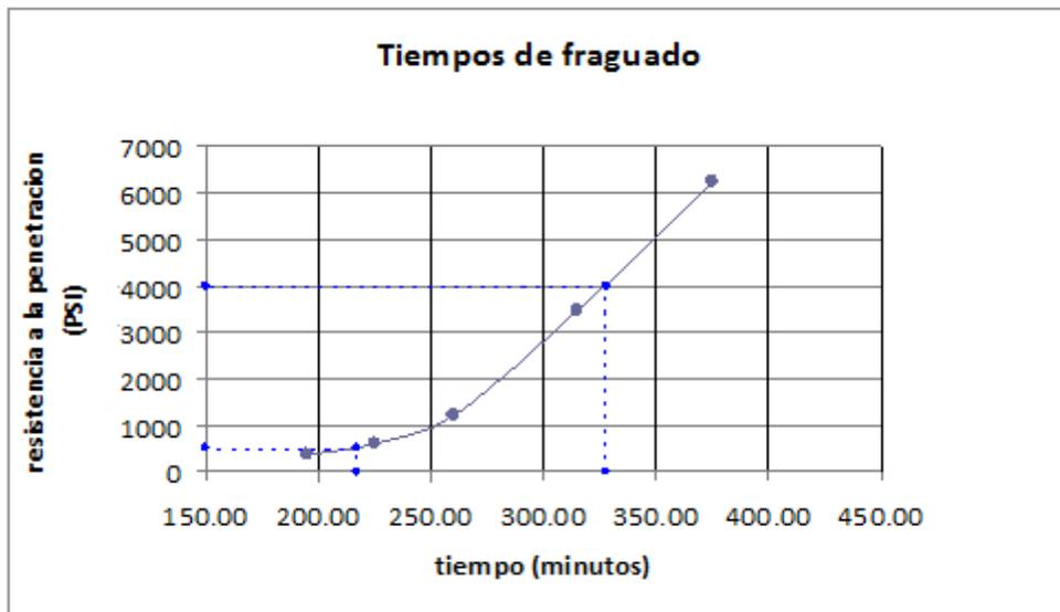
Figura 3.59 Gráfico que muestra la edad del fraguado inicial y final de las muestra 2
