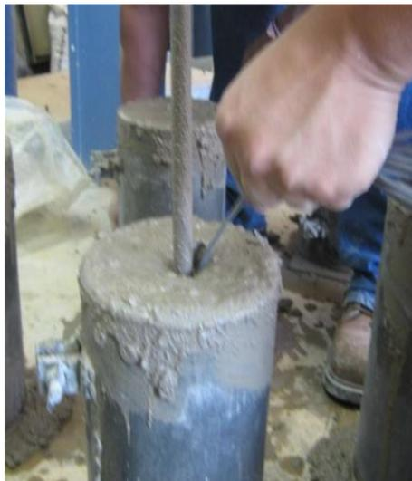
Figura 3.21 La varilla empujara cualquier partícula que interfiera en el trayecto del sensor
