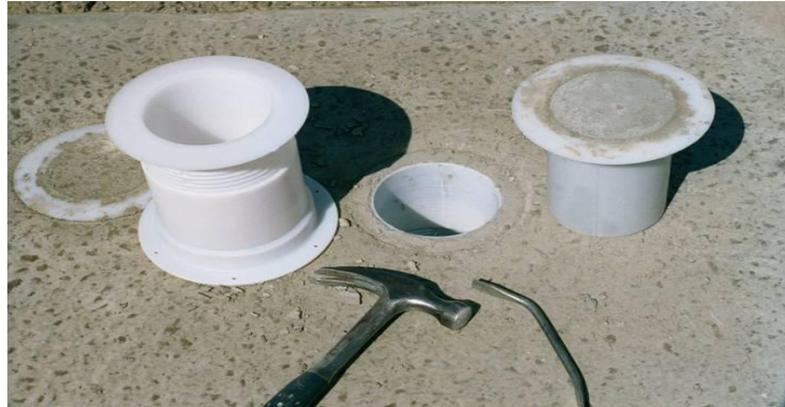
Figura 2.30 Moldes cilíndricos para especímenes colados en el sitio,
