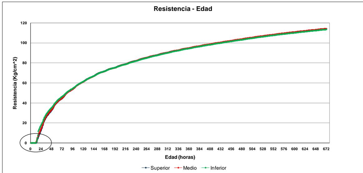
Figura 4.12 Gráfica de Resistencia – Edad para intervalos de 20 minutos durante 28 días
