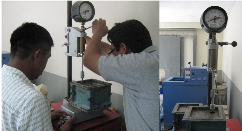
Figura 3.57: Penetración de los especímenes bajo tiempo controlado
