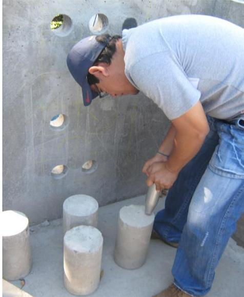
Figura 3.69: Ensayo de número de rebote en cilindros
