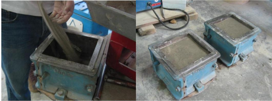
Figura 3.39 Elaboración de cubos para tiempos de fraguado
