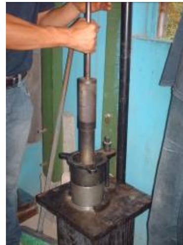
Figura 3-1. Colocación de molde en compactador manual e inicio de compactación.
