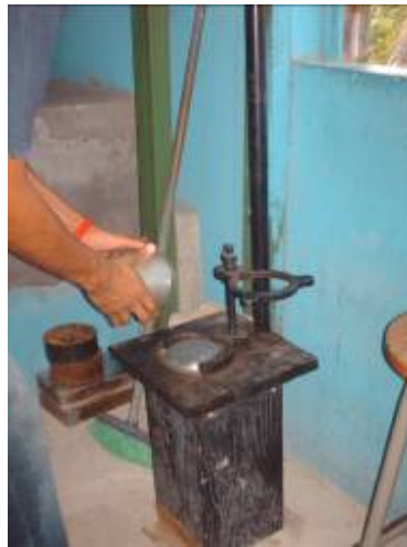
Figura 3-1. Colocación de molde en compactador manual e inicio de compactación.
