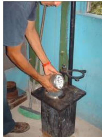
Figura 3-2. Finalización de compactación y retiro de probeta.
