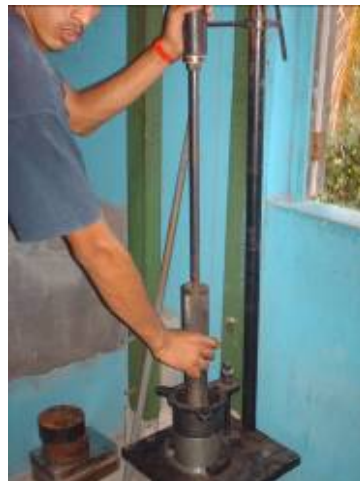
Figura 3-2. Finalización de compactación y retiro de probeta.
