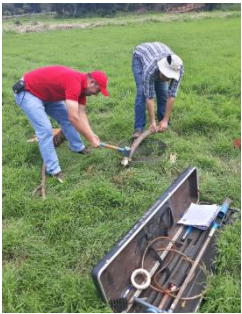
Figura 1. Prueba con cilindros infiltrómetros.
