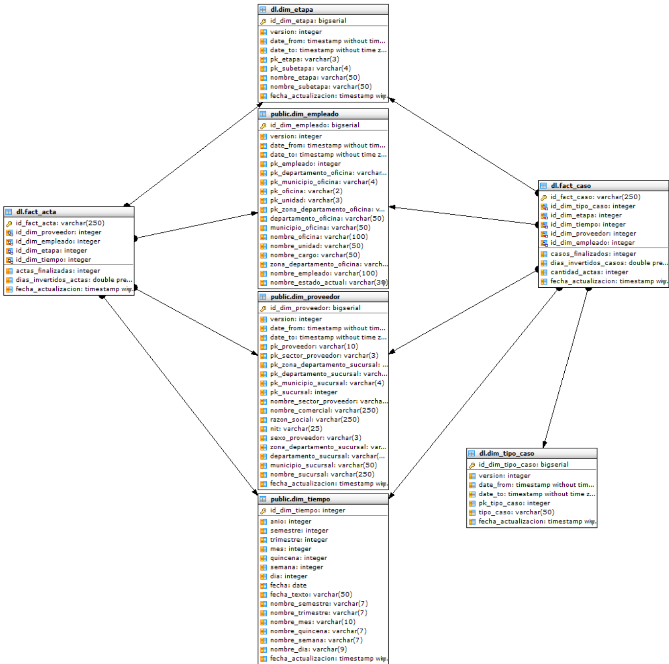
Figura 12.11: Diagrama Físico Base de Datos Datama
