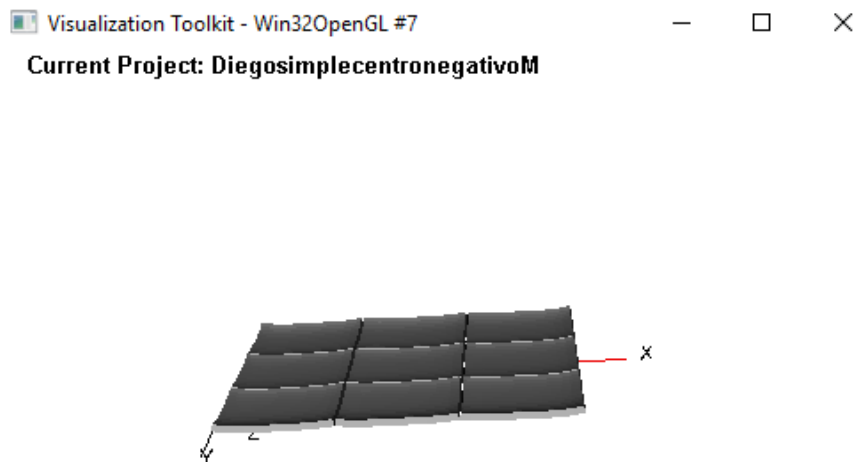
Figura 5.20 Deformación de la configuración de losas debido principalmente al gradiente térmico negativo.
