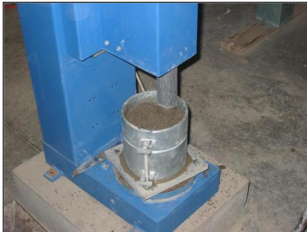
**FIGURA 3.4** Compactación del material, mediante Proctor Mecánico (ASTHO T 180)
