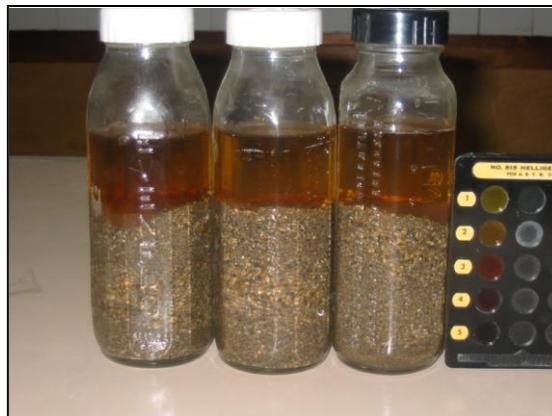
**FIGURA 3.2** Muestras para determinación de impurezas orgánicas en agregados finos.
