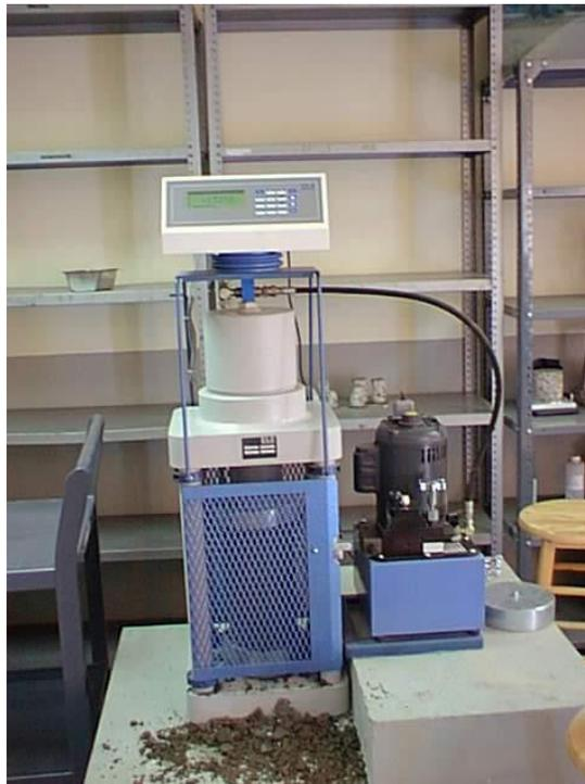
**FIGURA 3.11** Elaboración de prueba de compresión a cilindros.
