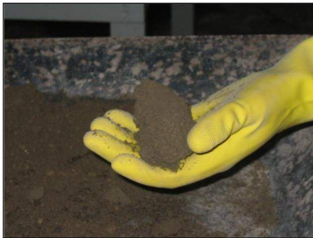
**FIGURA 3.3** Grumo de concreto, resultante de la elaboración de la prueba empírica manual para la determinación de la humedad óptima.
