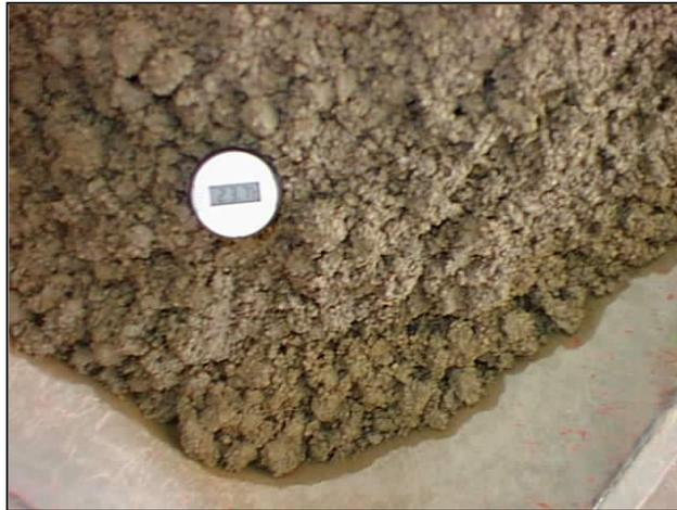
**FIGURA 3.9** Toma de temperatura de las mezclas elaboradas.
