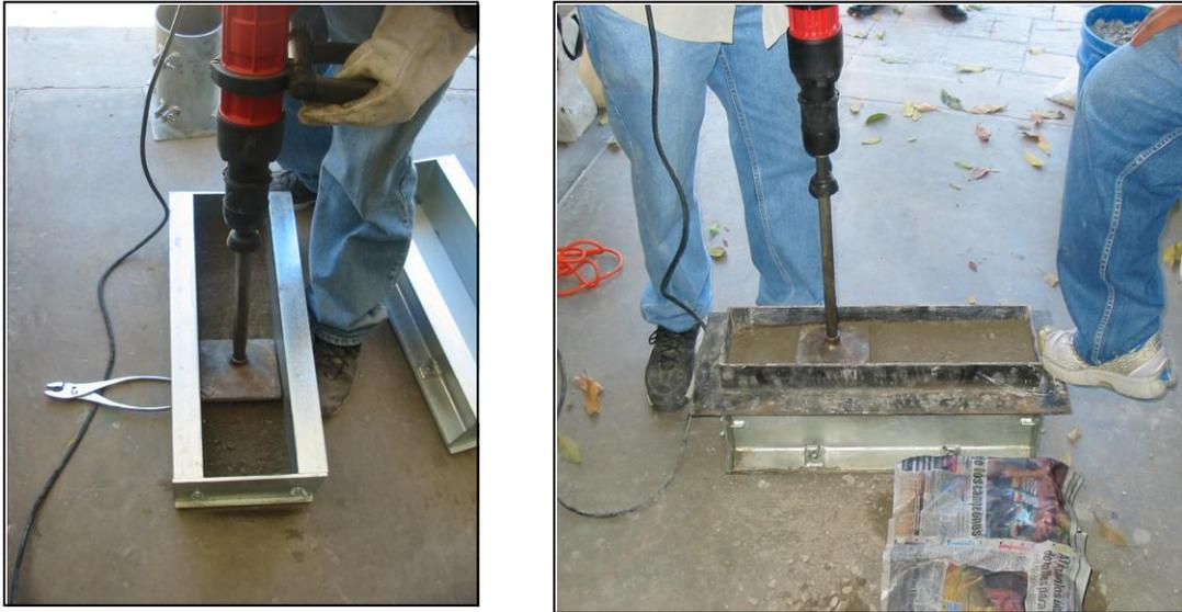
**FIGURA 3.8** Compactación de viguetas y extensión utilizada para la compactación de la última capa.
