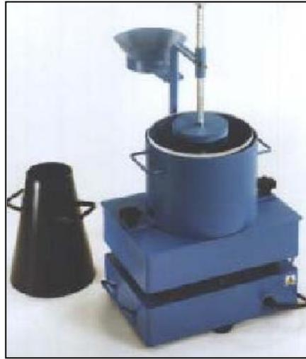
FIGURA 2.20. **Consistómetro VeBe, descrito en ACI 211.3.**
