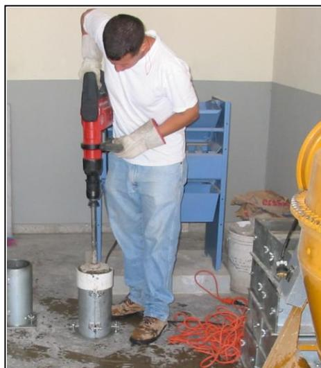
**FIGURA 3.6** Compactación de la tercera capa del cilindro utilizando el martillo vibrocompactador.
