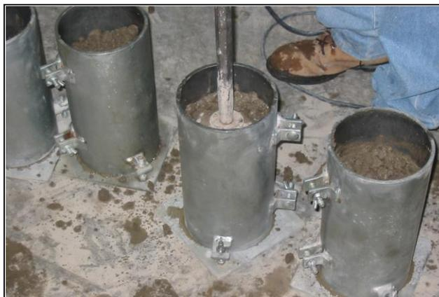
**FIGURA 3.5** Compactación de la segunda capa del cilindro.
