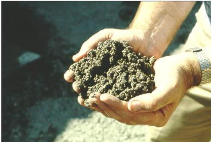
**FIGURA 2.13** Consistencia de la mezcla.
