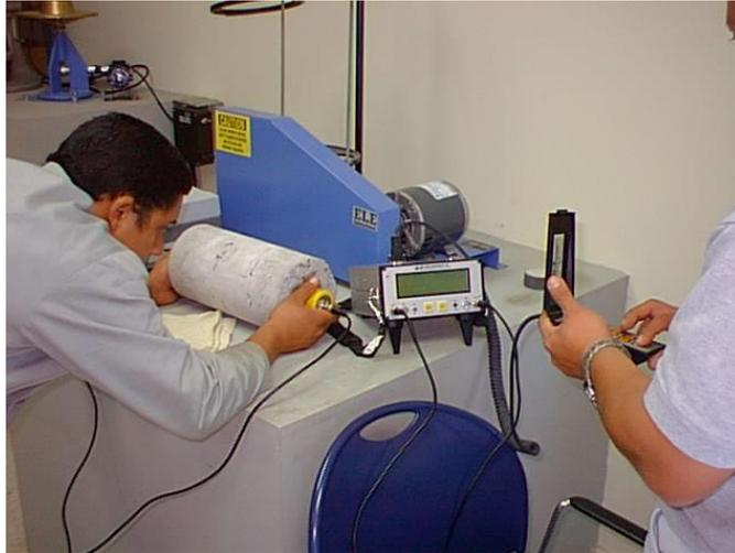
**FIGURA 3.14** Obtención de Módulo de Elasticidad Dinámico a través de pulso ultrasónico.
