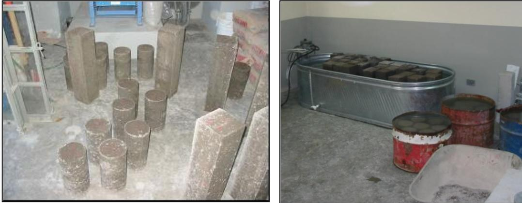
**FIGURA 3.10** Desenmoldado y curado de especímenes.
