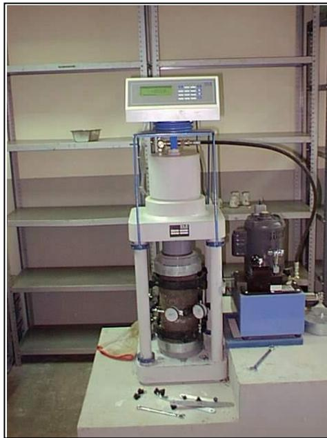
**FIGURA 3.13** Obtención del módulo de elasticidad y módulo de Poisson a través del Extensómetro-Compresómetro.
