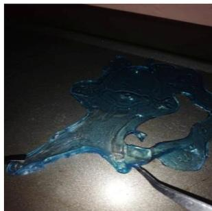
Levantar la muestra con ayuda de pinzas y estirar de forma que la muestra adelgace. Identificar el trozo de muestra con el código correspondiente
