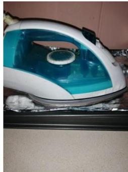
Colocar una plancha eléctrica caliente sobre la placa de metal superior por un minuto
