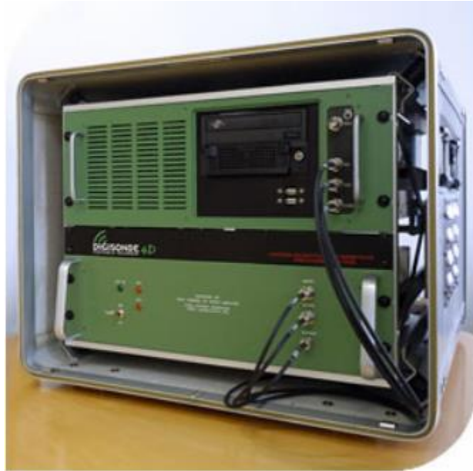
Figura 15. Estación de Digisonde D4.
