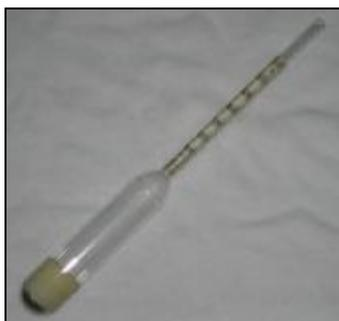
**Figura 5.1.** Densímetro utilizado para efectuar la medición de la densidad relativa en el biodiesel.
