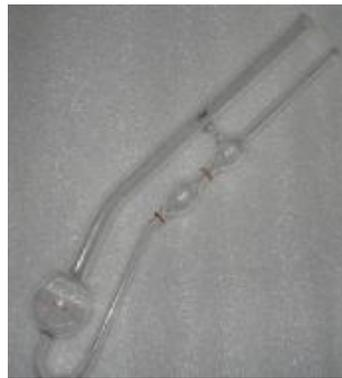
**Figura 5.2.** Viscosímetro utilizado para la determinación de la viscosidad del biodiesel.
