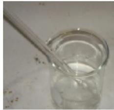
12. Prepara el metóxido de sodio dos horas antes de iniciar la segunda etapa: mide 120 ml de metanol por cada litro de aceite/grasas (12% en volumen) y 3.1 gramos de NaOH por cada litro de aceite/grasas (3.5 gramos si dudas de la pureza del NaOH). Agrega el NaOH en el metanol y revuelve hasta que se disuelva completamente (comenzar a hacer esta mezcla por lo menos 1 hora y media antes de usar).
