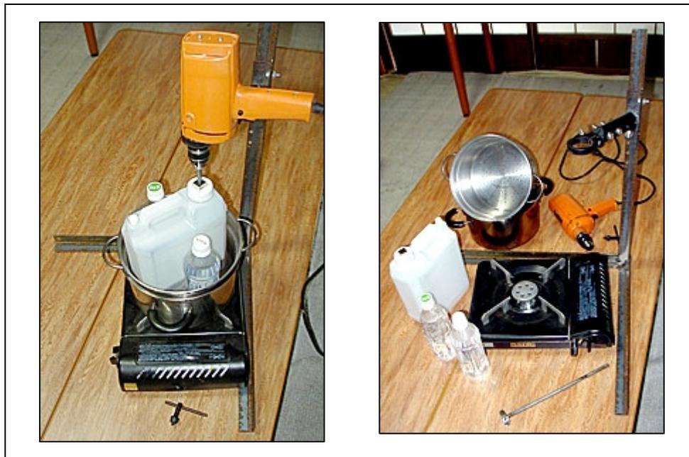
**Figura A 2.3.** Esquema del reactor casero elaborado para la producción de Biodiesel.
