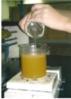
14. Luego, a esta temperatura verter la mitad del metóxido, mantener agitación uniforme durante cinco minutos, esto neutraliza el ácido sulfúrico de la primera etapa y ayuda a que se produzca la catálisis alcalina. Pasados los 5 minutos verter la segunda mitad de metóxido.
