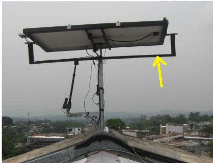
**Figura C.2** Para aflojar el eje es necesario aplicar una fuerza indicada por la flecha.
