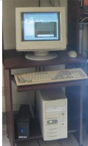
El sistema de seguimiento solar fue monitoreado 6 semanas junto con el sistema fotovoltaico fijo, permitiendo hacer una justa comparación de los parámetros que nos interesan, como lo son irradiación solar, producción de los paneles, etc. Durante este tiempo, un datalogger KEITHLEY 2700 se instaló en el laboratorio de aplicaciones fotovoltaicas, junto con una computadora que extraía los datos constantemente, a fin de evitar pérdidas de los mismos.
