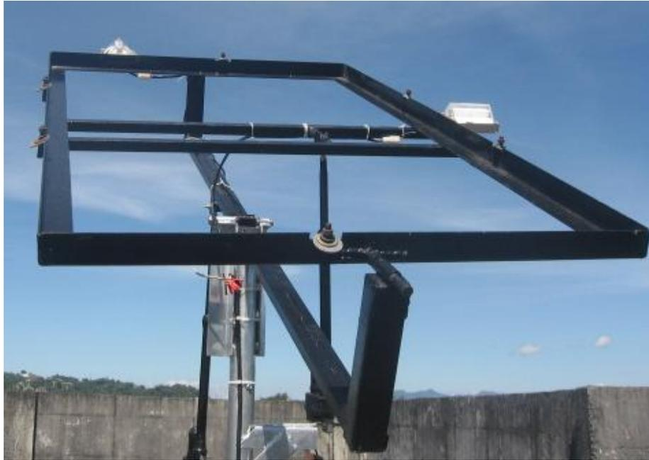
Figura 3.12 Plataforma diseñada para el panel fotovoltaico.
