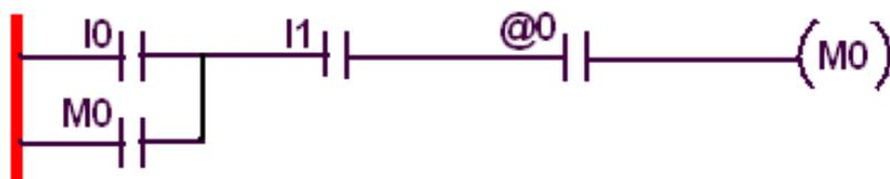
Figura 4.15 Línea de comandos principal para encendido y apagado diario.[Elaboración propia]
