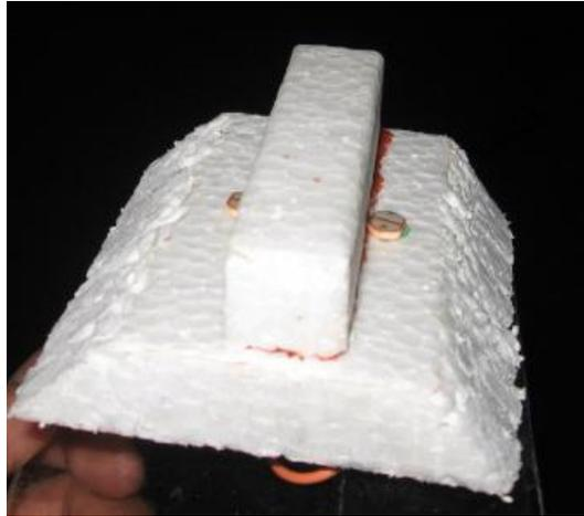
**Figura 2.3 Disposición de los sensores LDR's utilizados para captar la luz del Sol. [1]**
