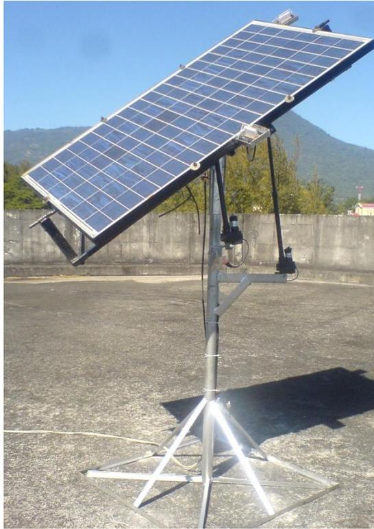
**Figura 3.24 Estructura provisional para pruebas sobre el edificio de la Biblioteca del área de ingenierías y arquitectura UES.**
