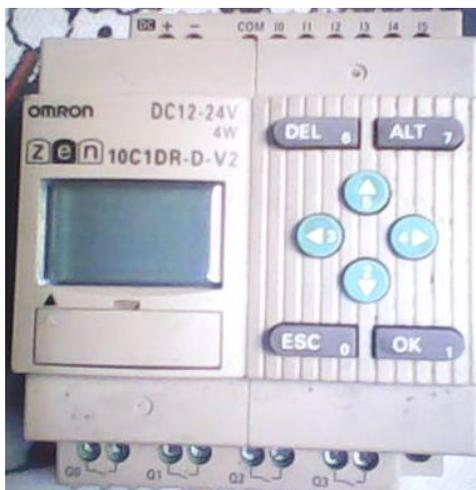
Figura 4.5 Imagen de Relé ZEN OMRON utilizado.
