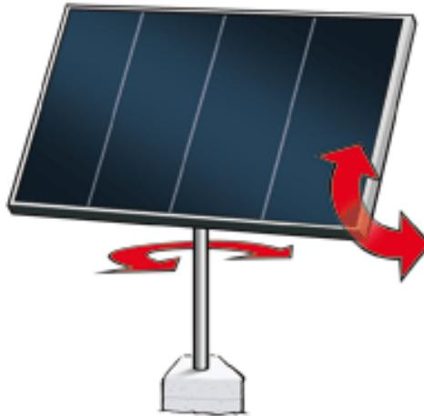
Figura 3.4 Ejemplo de estructura mono-poste.
