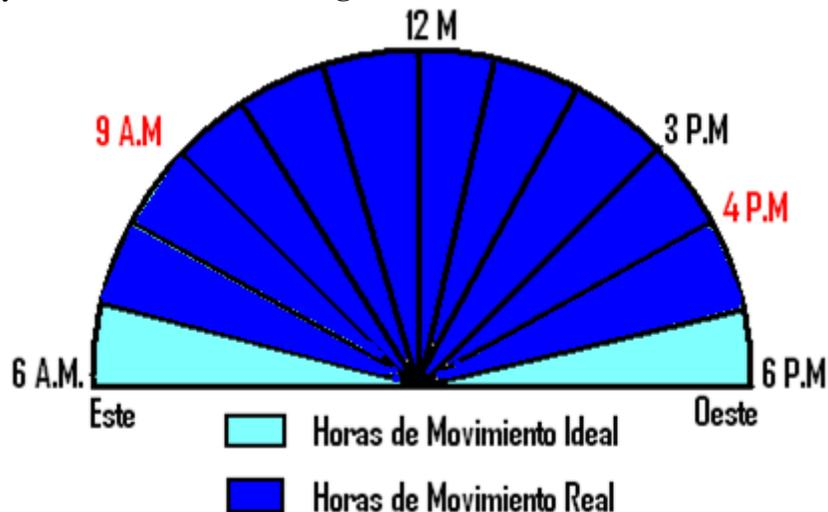
Figura 3.13 Descripción en horas de los movimientos requeridos por el sistema. [Elaboración propia]
