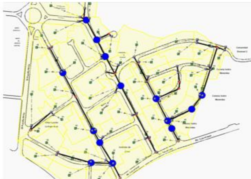
Figura 4.15. Muestra los pozos colectores que rebalsan. Fuente: Elaboración propia utilizando el software SSA.
