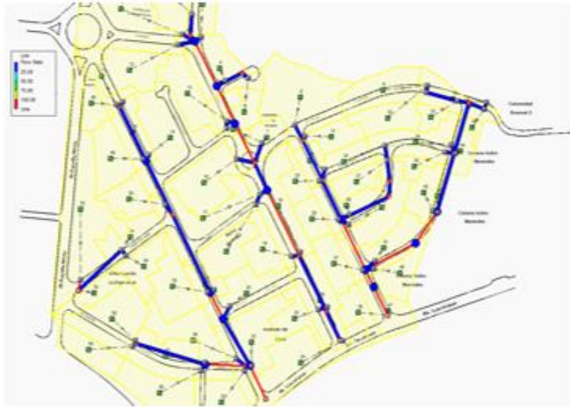
Figura 4.12. Estado actual de la red de alcantarillado Fuente: Elaboración propia utilizando el software SSA.
