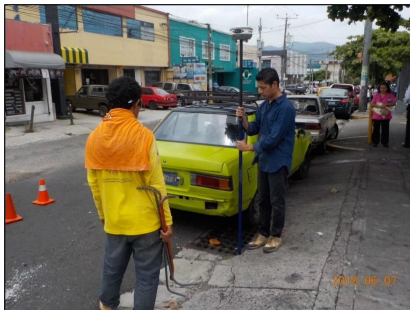
Figura 3.14. Toma de coordenada en tragante.
