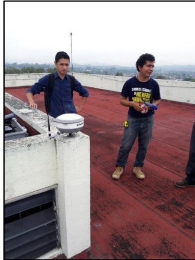
Figura 3.8. Sincronización de la BASE con la colectora por conexión Bluetooth.
