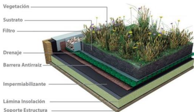
Figura 5.2. Estructura de un techo verde.
