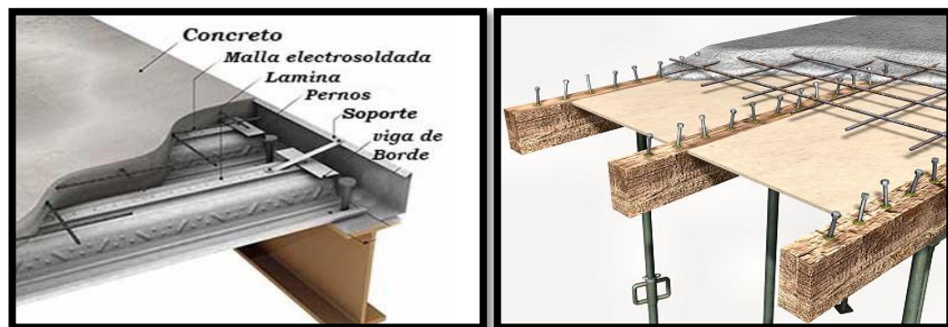
Figura 2.7: Losas combinadas. Fuente: https://construyendo.co/losas/steelDeck.php . http://www.mexico.generadordeprecios.info/rehabilitacion/Estructuras/Madera/Refuerzos/EMZ310_Refuerzo_de_losa_de_madera_mediant.html .
