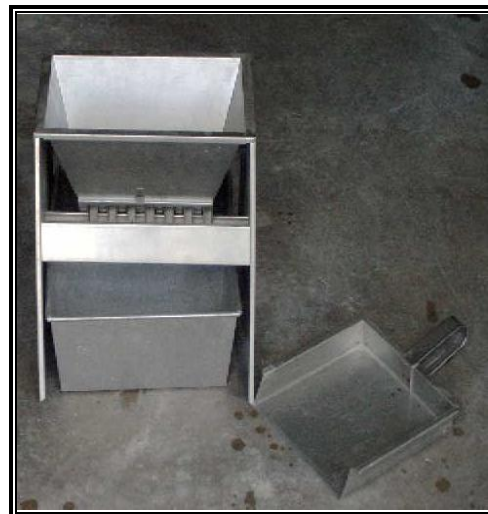
Figura 3.6: Partidor Mecánico para Agregado Fino.
