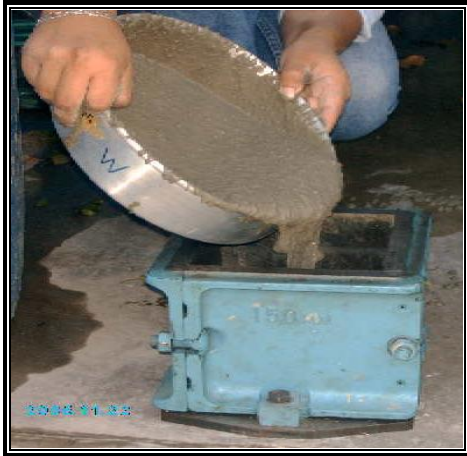
Figura 3.31: Hechura de Especímenes para Tiempo de Fraguado
