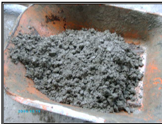
Figura 3.18. Mezcla de Concreto, bajo el Diseño del ACI 211.1
