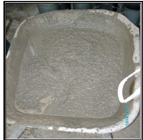
Figura 3.23: Se Observó Sangrado en la Mezcla de Concreto Utilizando un Aditivo a Base de Melanina.
