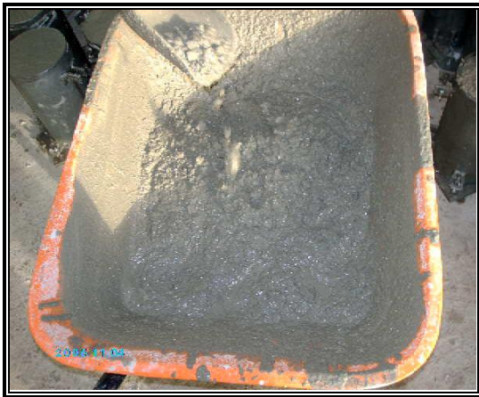
Figura 3.22: Se observan Sangrado en la Mezcla de Concreto Utilizando un Aditivo a Base de Melanina.
