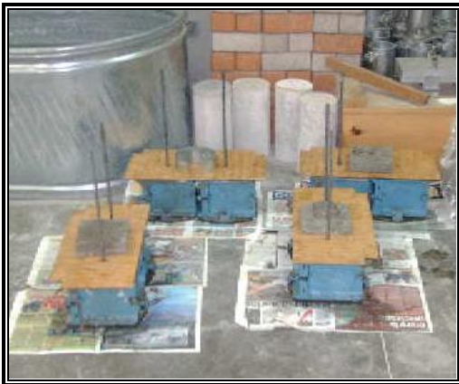
Figura 3.38: Hechura de Especímenes para Ensayo de Adherencia.
