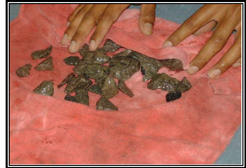
Figura 3.11: Secado de Agregado Grueso
