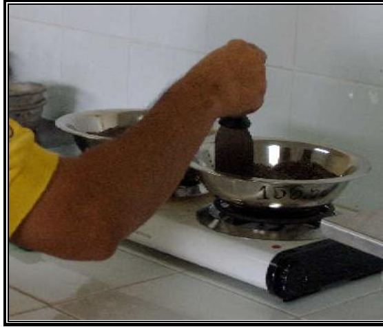
Figura 3.15: Determinación de la Humedad de los Agregados
