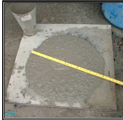
Figura 3.30: Ensayo de Extensibilidad
