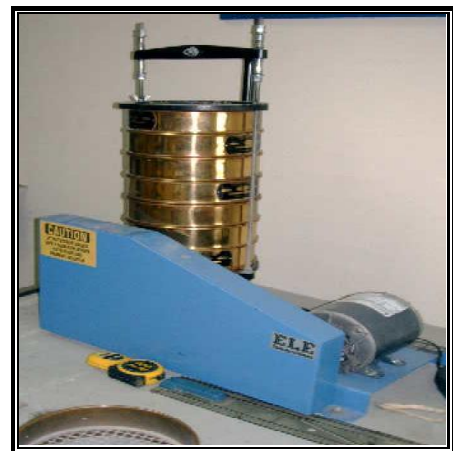
Figura 3.9: Equipo Utilizado para la Granulometría del Agregado Fino (Rop-Tap)
