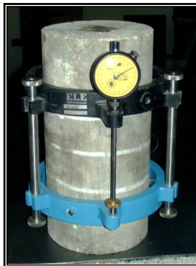
Figura 3.37: Ensayo para Calcular el Módulo de Elasticidad
