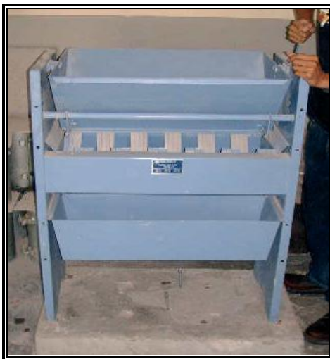
Figura 3.5: Partidor Mecánico para Agregado Grueso.
