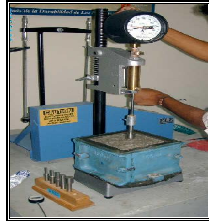
Figura 3.32: Realización de la Prueba de Fraguado para el Concreto
