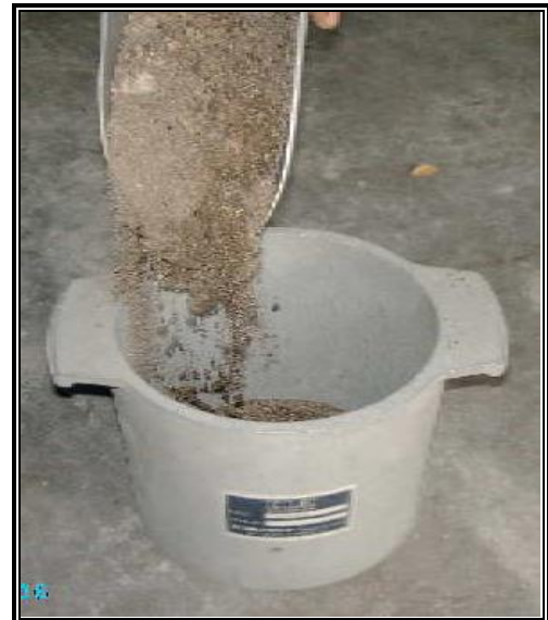
Figura 3.14: Determinación del Peso Unitario para Agregado Fino.
