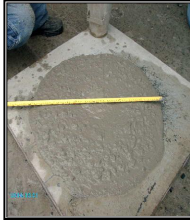
Figura 3.26: Extensibilidad de 65 cm en la Mezcla Óptima.
