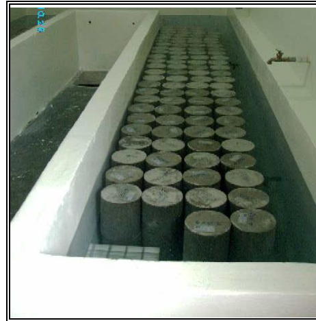
Figura 3.29: Curado de los Especimenes
