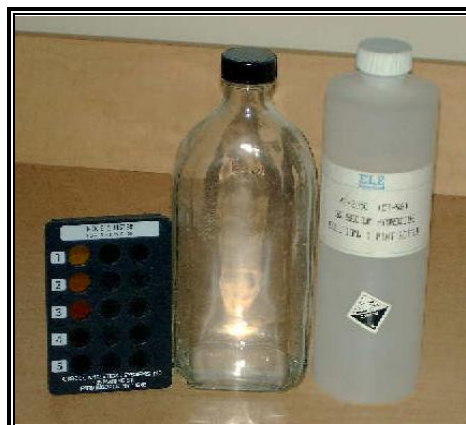
Figura 3.7: Ensayo para la Determinación de las Impurezas en el Agregado Fino.
