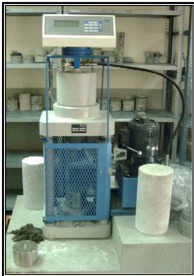
Figura 3.34: Máquina de Compresión
