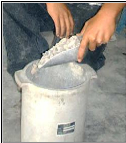
Figura 3.13: Determinación del Peso Unitario para Agregado Grueso.
