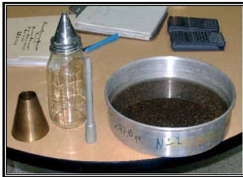
Figura 3.12. Equipo Utilizado para la Determinación de la Gravedad Especifica del Agregado Fino.
