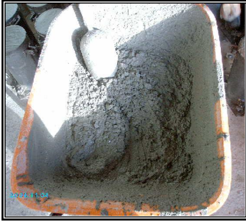
Figura 3.21: Rápida Pérdida del Revenimiento de Mezclas de Concreto al Utilizar un Aditivo Superfluidificante a Base de Policarboxilatos
