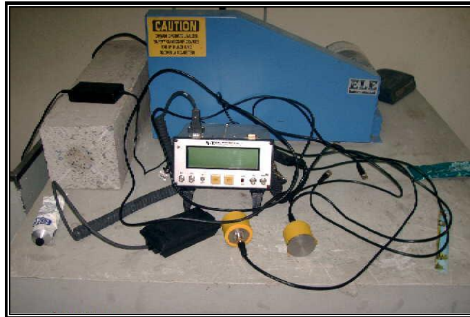
Figura 3.36: Dispositivo Utilizado para la Determinación del Módulo de Elasticidad Dinámico en el Concreto.
