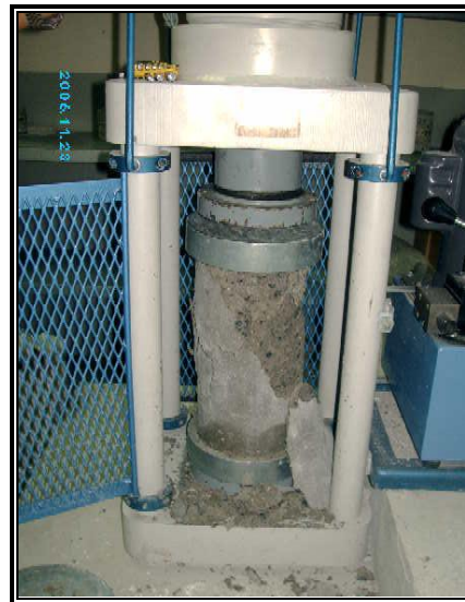
Figura 3.35: Ruptura de un Especimen.
