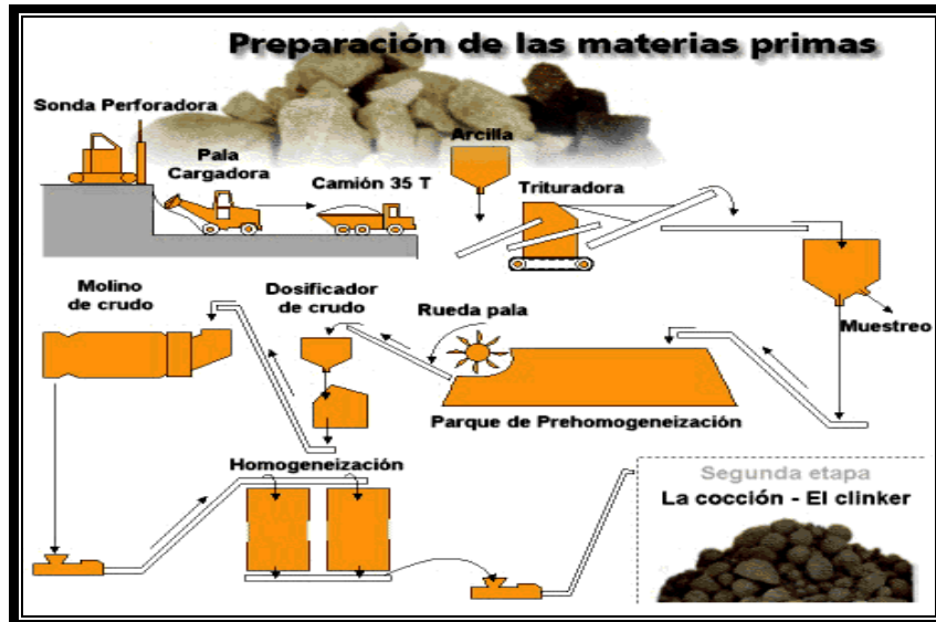
Figura 2.23: Preparación de las Materias Primas. Tomada de www.cessa.com.sv
