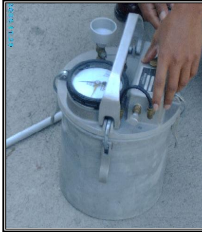
Figura 3.33: Equipo Utilizado para la Determinación del Contenido de Aire en la Mezcla de Concreto
