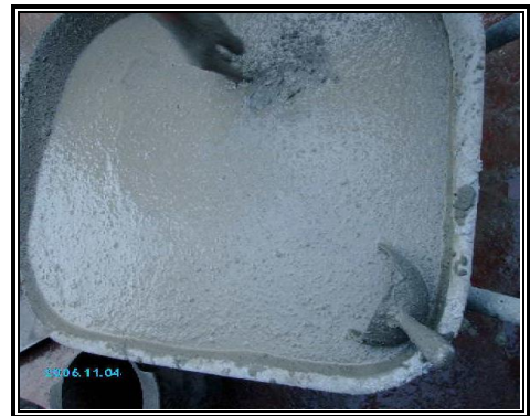
Figura 3.20: Problemas de Segregación al Utilizar un Aditivo a Base de Policarboxilatos
