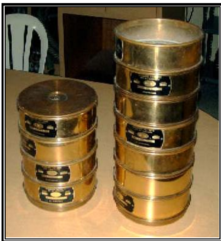
Figura 3.8: Mallas para Granulometría del Agregado Grueso
