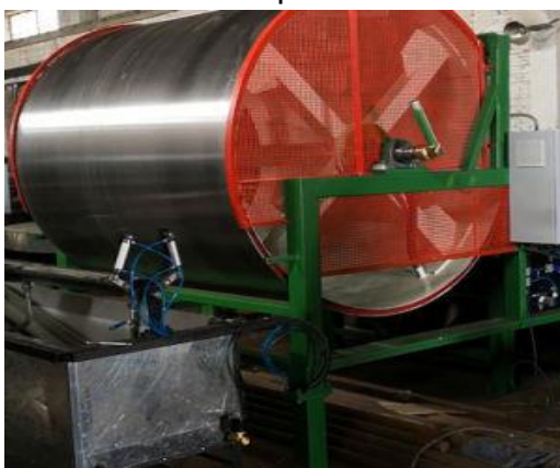
Figura 8. Tambor donde se forman los gránulos de parafina. [Fotografía]. Fuente: (Cooperation, 2018).
