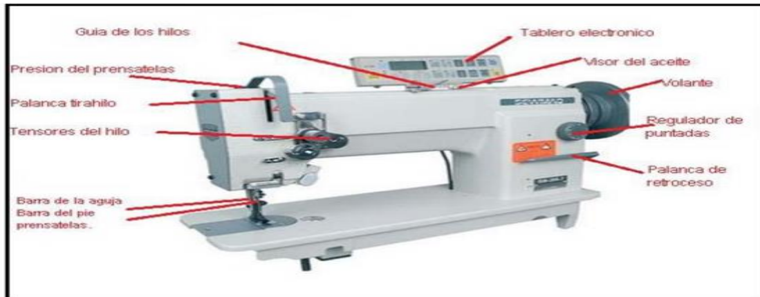
Ilustración 75 Piezas de maquina plana
