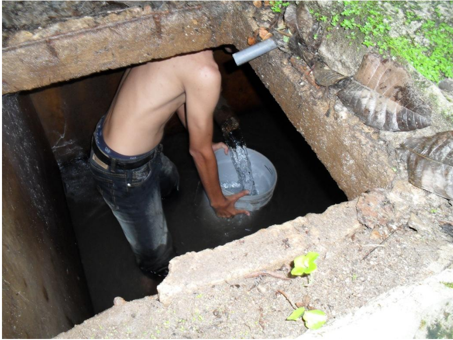
FOTO 3. AFORO DE CAPTACIÓN.
