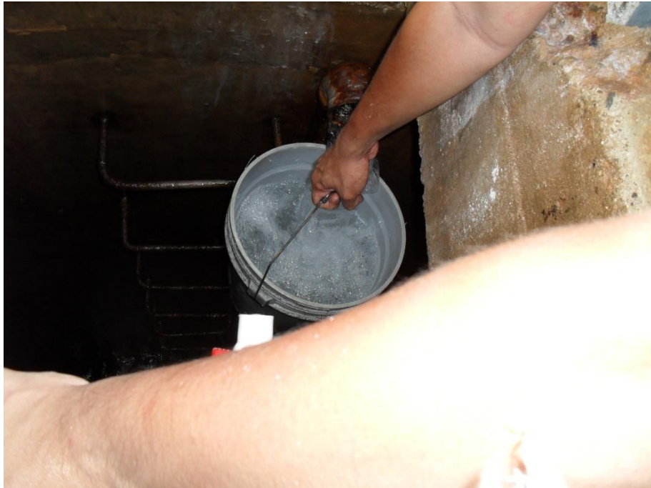
FOTO 7. AFORO DEL CAUDAL EN EL TANQUE DE ALMACENAMIENTO.
