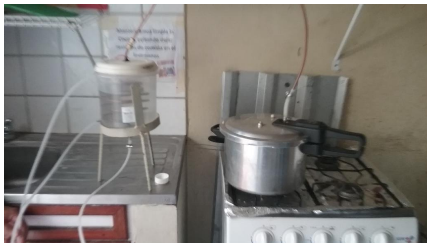
Figura 2 vista de la cámara de extracción y el condensador.
