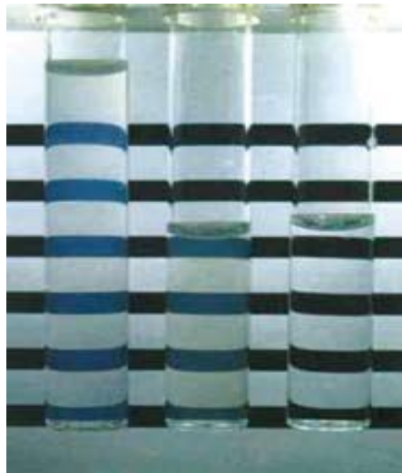
Figura 2. Ejemplo de comparación del estándar McFarland con tubo contaminado.
