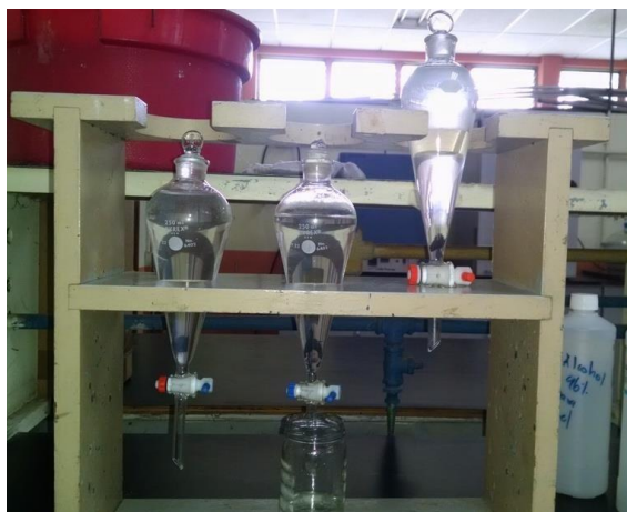
Ilustración 3.4 Separación de aceite esencial de eucalipto del hidrolato.
