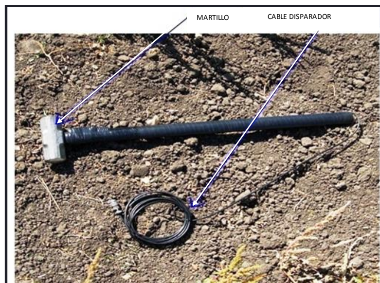
Figura 3.63 Martillo de trineo como fuente de energía sísmica comúnmente usada en pruebas de refracción sísmica, y su cable que va conectado al sismógrafo. [www_aorangeophysics.com].
