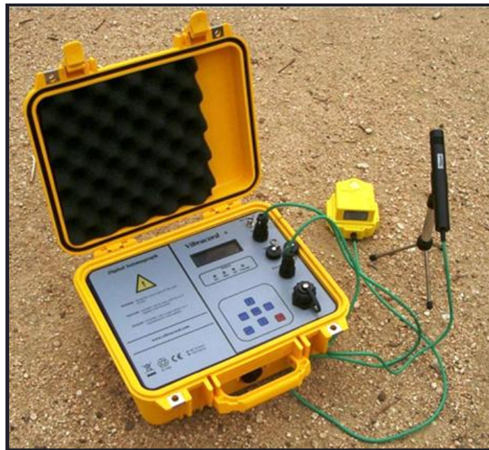
Figura 3.65 Sismógrafo de 7 canales para conectar igual número de geófonos con rango de frecuencias de 0 – 512 Hz, utilizado para inspección de refracción sísmica [www.pmicam.com].
