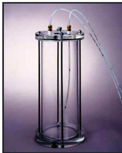
Figura 3.22 Tanque de Desaereación de Agua Tri-Flex 2.
