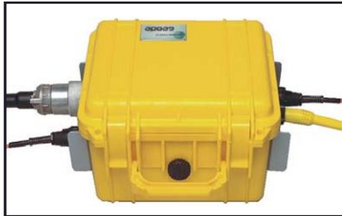
Figura 4.3 Sismógrafo de exploración marca GEOMETRICS para la prueba de Refracción Sísmica. [Cotizado a CORESA S.A de C.V. ]
