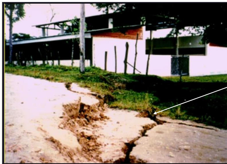
Figura 2.6 Licuefacción de suelos en Tahuishco, Moyobamba Perú, sismo de 1990.
