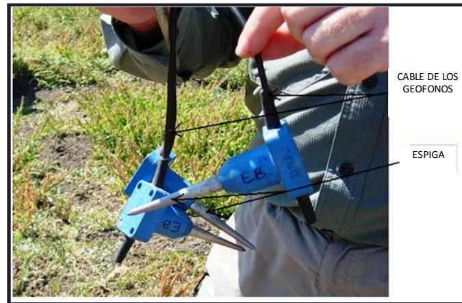
a) Geófonos verticales utilizados para detección de ondas sísmicas (P). [www.pmicam.com].
