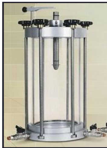
Figura 4.1 Cámara triaxial para presiones de trabajo máximas de 1700 Kpa.
