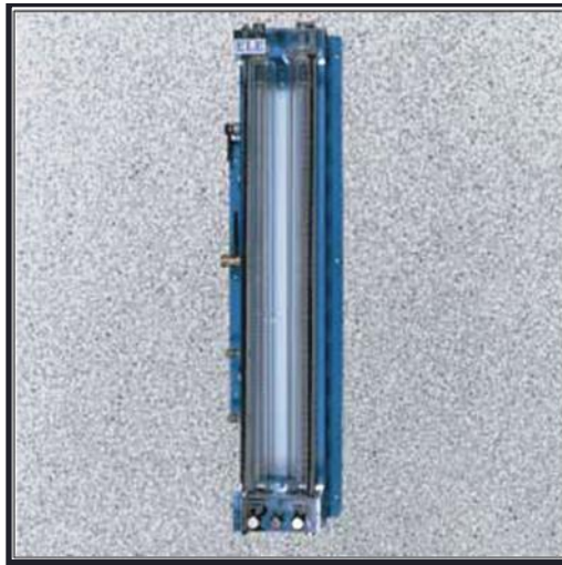
Figura 3.18 Unidad de Cambio Volumétrico de Doble Bureta (Método Manual).
