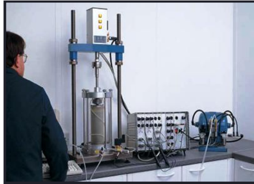
Figura 3.12 Sistema electro-hidráulico de circuito cerrado; el cual consta de un bastidor de carga con un actuador neumático servocontrolado, una cámara de ensayo triaxial, panel de control triaxial y un sistema de control y adquisición de datos. [ http://eleusa.com/pdf/spanish/triaxial.pdf ].
