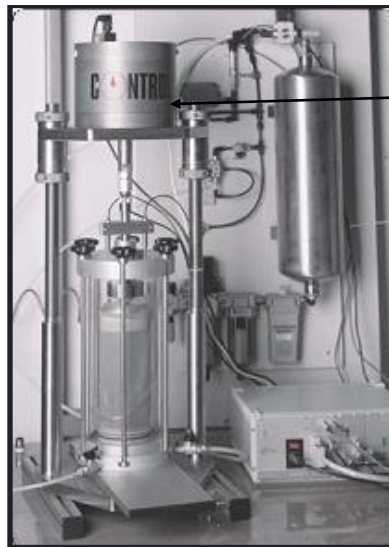
Figura 4.2 Equipo de carga cíclica en conjunto con la cámara triaxial.
