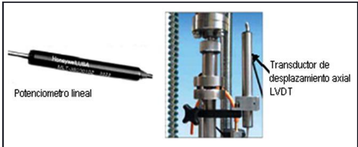
Figura 3.31 Transductor y potenciómetro para medición de deformación axial.
