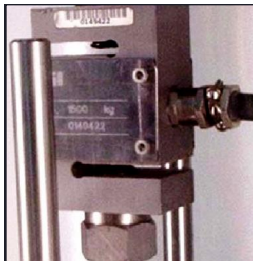
Figura 3.47 Celda de carga de 15 kN para medir variaciones de fuerza del cilindro pistón.
