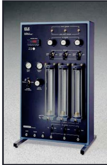
Figura 3.15 Panel de control principal Tri-Flex2. El sistema actúa como un medidor y controlador de la presión, por medio de tres reguladores de presión controlados individualmente - uno para la presión de confinamiento o de celda; otro para la presión inferior o de poro/cabeza; y otro para la presión superior o contrapresión/cola. [ http://eleusa.com/pdf/spanish/triaxial.pdf ].
