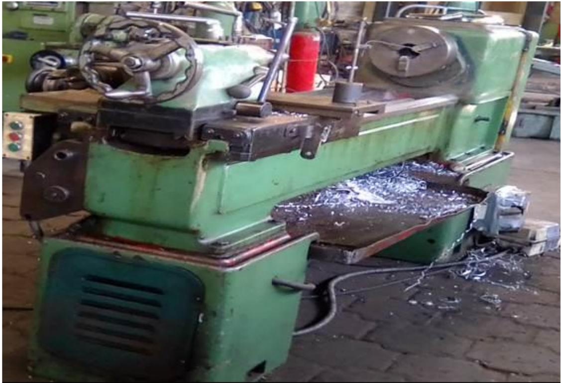
Figura 2.4. Torno convencional marca COMEC.
