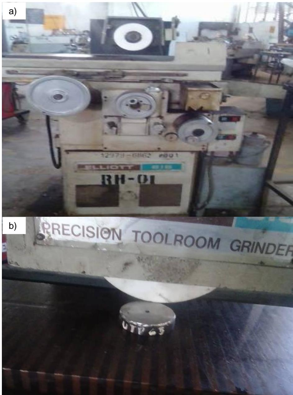
Figura 2.8. Proceso de rectificado: a) rectificadora y b) probeta montada en la rectificadora.
