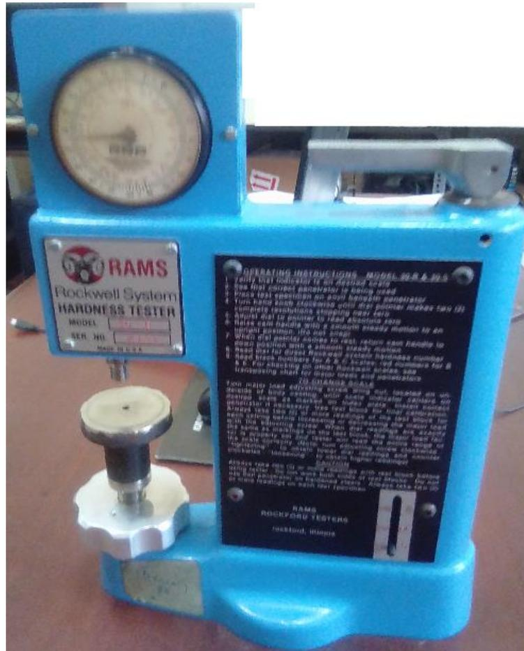
Figura 2.16. Durómetro marca RAMS.
