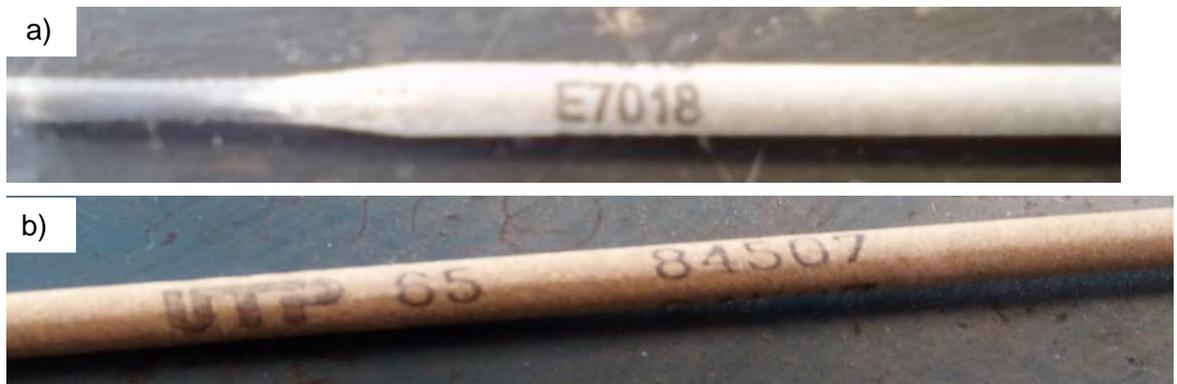
Figura 2.5. Electrodo utilizados para el calzado de los discos; a) E-7018 y b) UTP-65.
