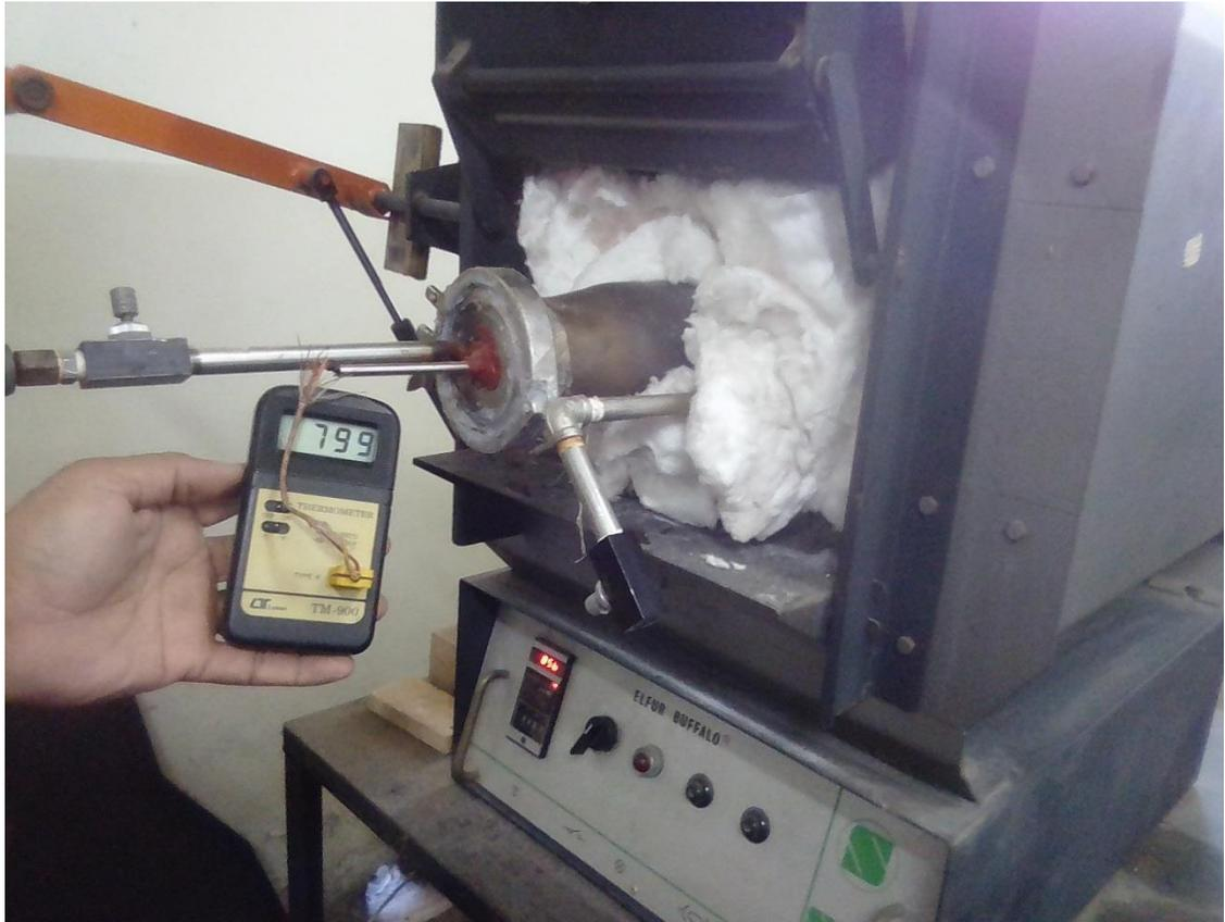
Figura 2.10. Cámara de gas inerte durante el tratamiento térmico de las espigas.
