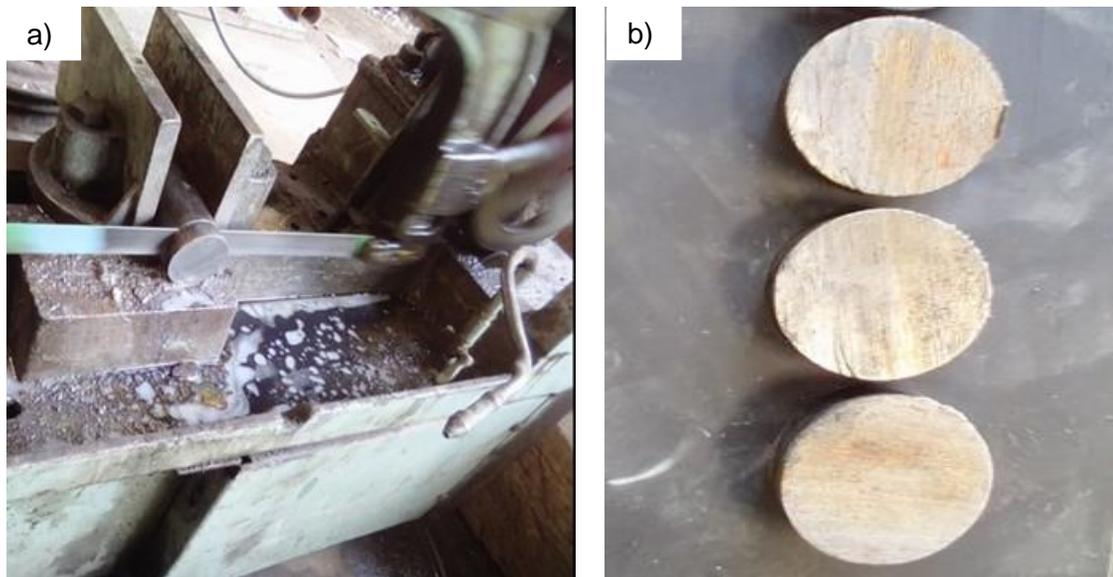
Figura 2.3. Proceso de corte de los discos: a) etapa de corte y b) discos cortados.
