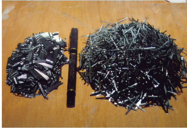
Fig. 2.18.b. Fibras Metálicas que son utilizadas en el Concreto Reforzado.
