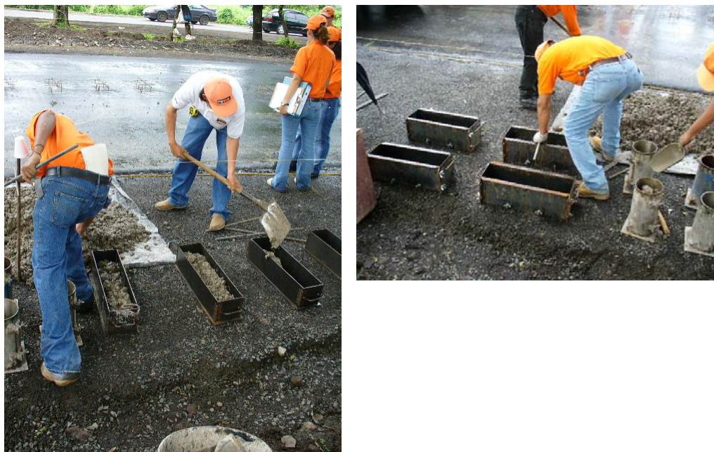
Figs. 4.11 y 4.12. Toma de Muestras para Ensayo de Flexión y Compresión del Concreto.
