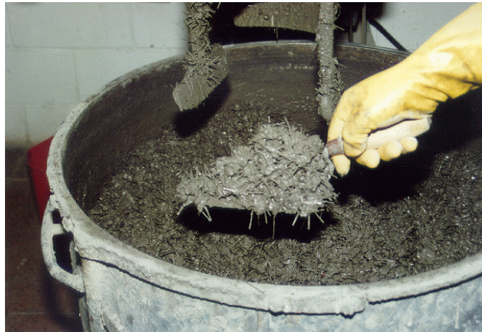
Fig. 2.18.c. Fibras Metálicas que son utilizadas en el Concreto Reforzado.
