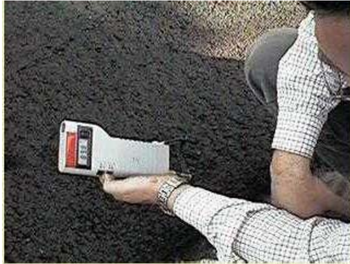
Figura 4.7. Medición de la temperatura.
