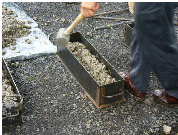
Figura 4.10. Toma de Muestras para Ensayos de Flexión del Concreto.
