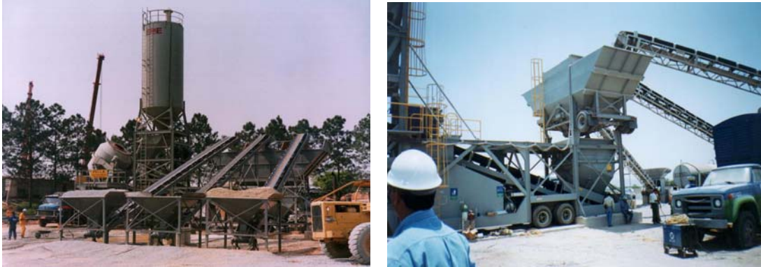
Figs. 3.24 y 3.25. Planta de Mezclas Móvil. Dosifica y Mezcla el Concreto.
