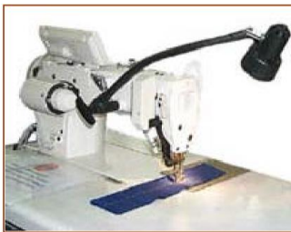
Figura 154: Alumbrado focalizado para operaciones especiales
