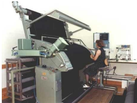
Figura 62: Máquina revisadora para tejidos de calada y géneros de punto abiertos.
