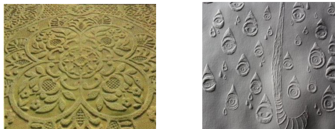
Figura 84: Dos sustratos textiles con gofrado: no tejido (izquierda) y tejido de calada (derecha)
