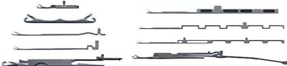
Figura 51: Diversos tipos de agujas para máquinas de género de punto
