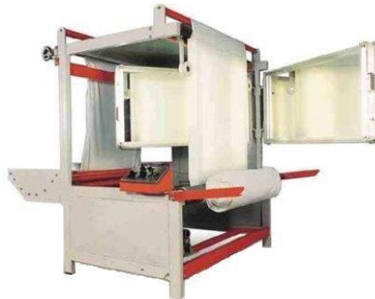
Figura 64: Revisadora para géneros de punto tubulares. Utiliza dos espejos que muestran ambos lados del tejido.
