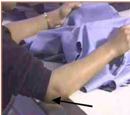
Figura 157: Operario que se reposa los brazos sobre bordes afilados
