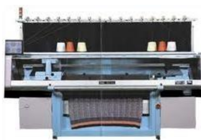
Figura 52: Tricotosa rectilínea (género de punto por trama)
