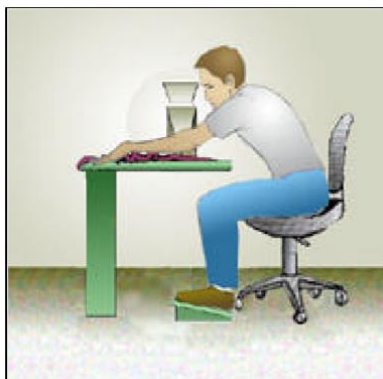
Figura 161: MÉTODO INADECUADO. Postura torpe que causa la tensión ergonómica a los brazos, a los hombros, y a la espalda.
