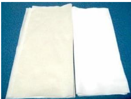
Figura 69: Tejido Descrudado (izquierda) y blanqueado (derecha)
