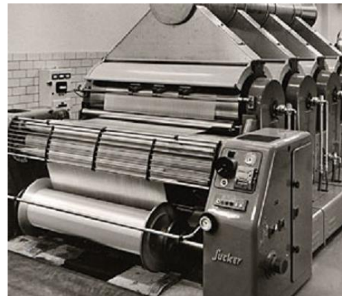
Figura 37: Salida de una engomadora, con el plegador de hilos de urdimbre ya engomados y secos
