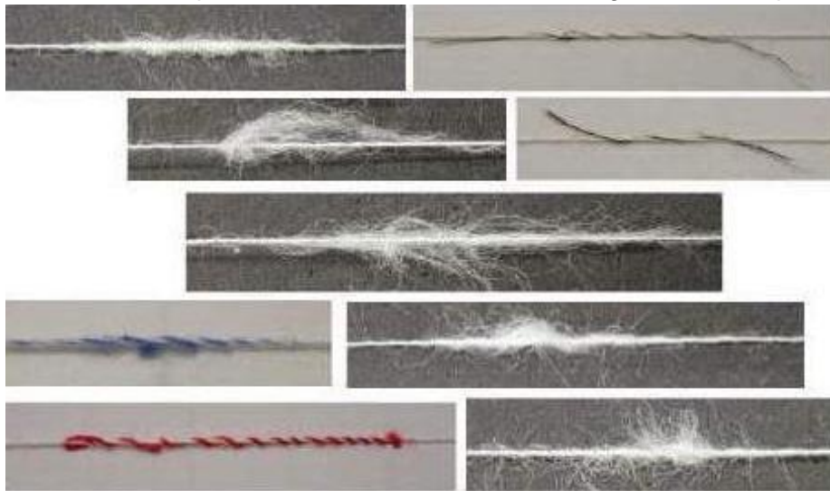
Figura 27: Defectos de hilo
