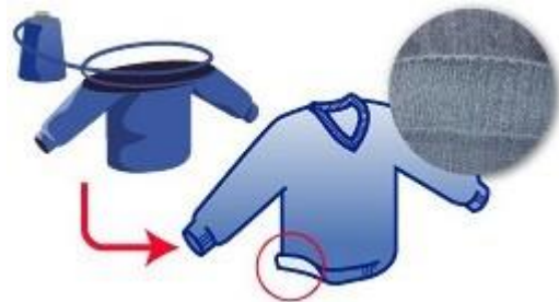
Figura 42: Fabricación de una prenda sin mermas por corte
